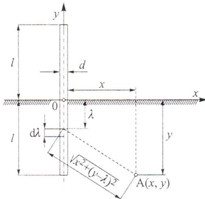
**Slika 5.4** Položaj štapnog uzemljivača za određivanje potencijala na površini zemlje i otpora uzemljenja [1]
