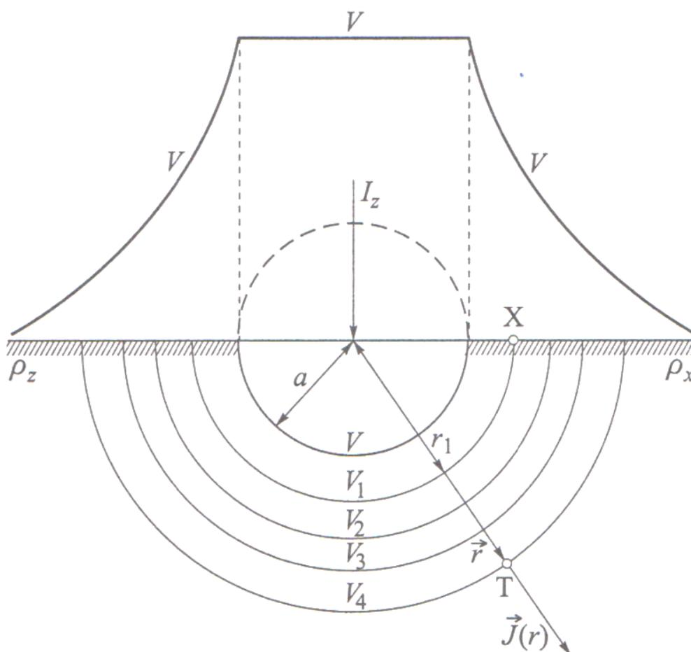
Slika 5.1 Razdioba potencijala za uzemljivač u obliku kugle [1]
