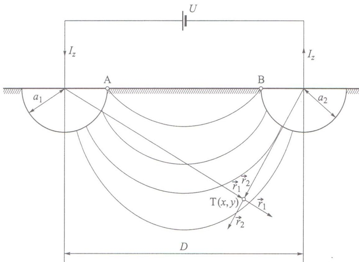
**Slika 5.2** Dva polukuglasta uzemljivača položena na površini zemlje [1]
