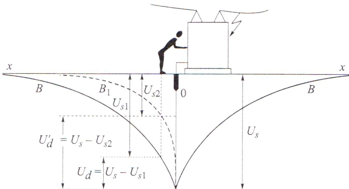
Slika 3.1 Raspodijela potencijala oko uzemljivača i napon dodira [1]
