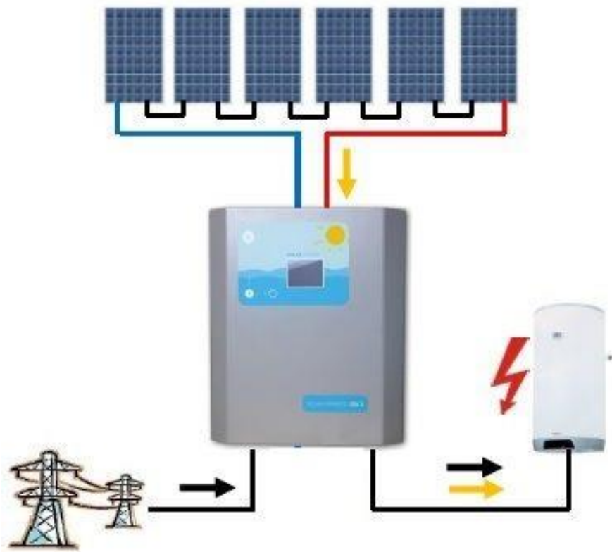
Slika 2.6 Fotonaponski sustav bez AC/DC izmjenjivača. [10]
