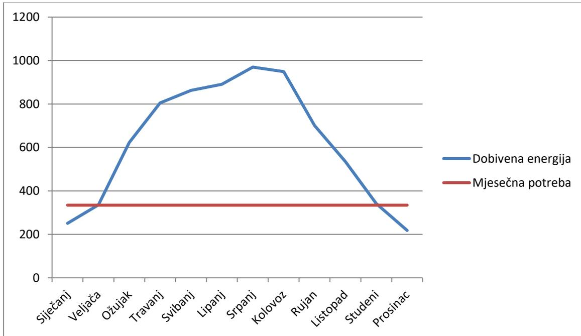
Slika 3.11. Prikaz dobivene energije sa 6 m<sup>2</sup> solarnih modula.
