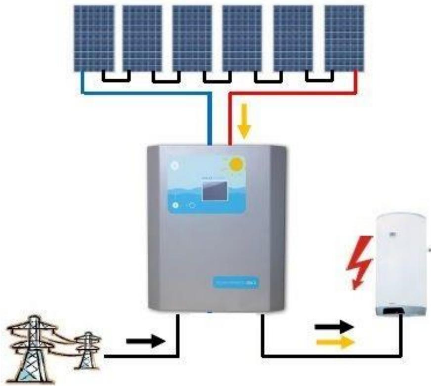
Slika 2.6 Fotonaponski sustav bez AC/DC izmjenjivača. [10]
