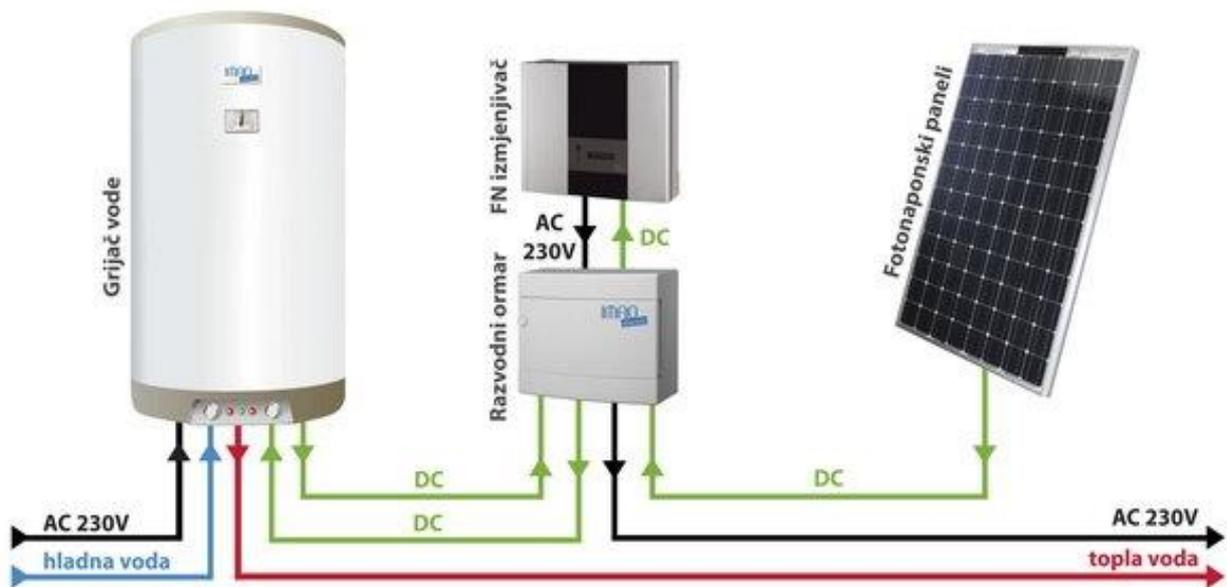
Slika 2.5. Fotonaponski sustav za pripremu potrošne tople vode. [9]
