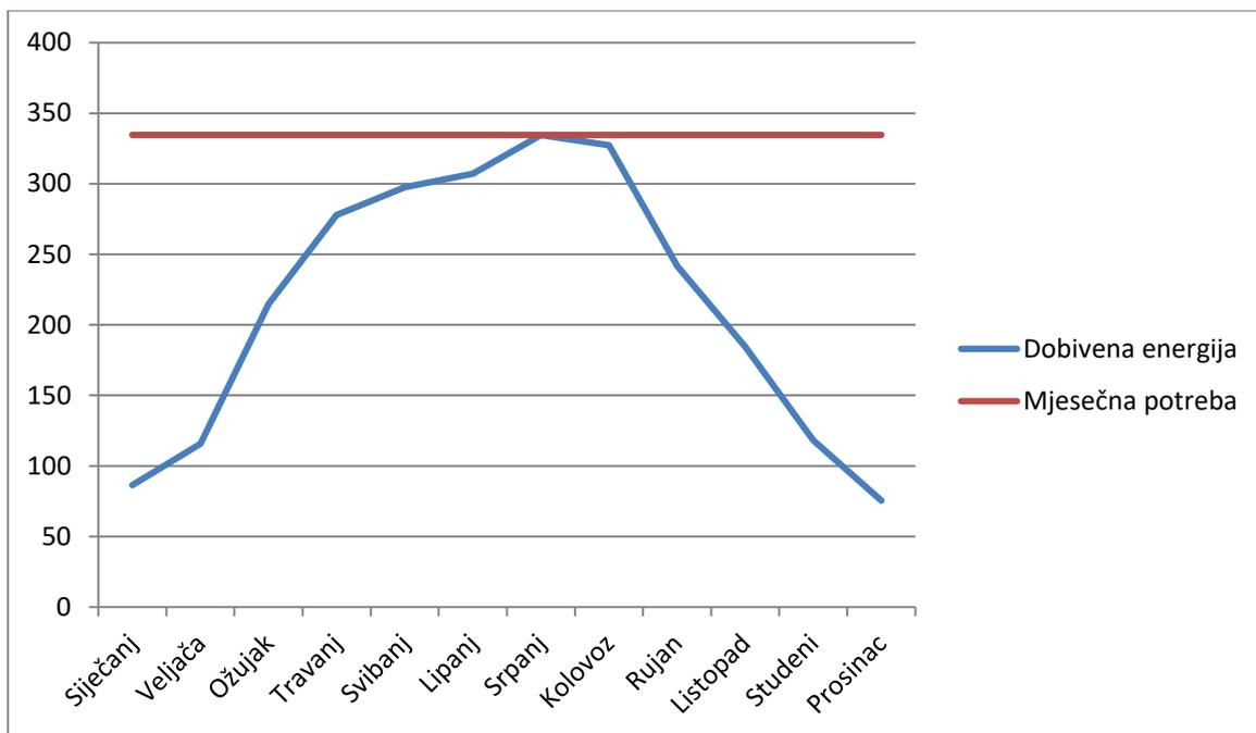
Slika 3.3. Prikaz dobivene enerije s 8 m<sup>2</sup> fotonaponskih modula.
