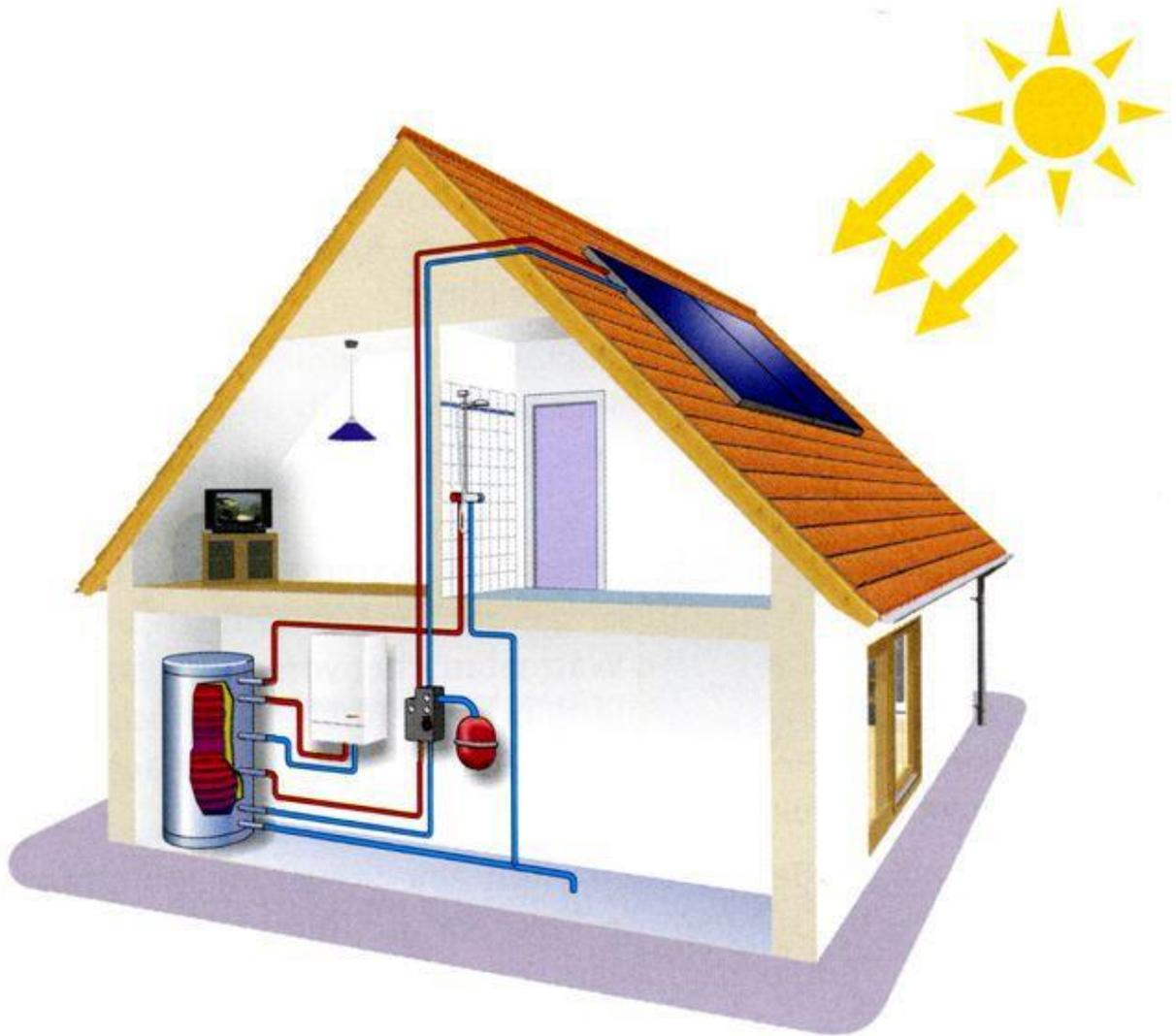
Slika 2.4. Solarni kolektorski sustav za pripremu potrošne tople vode. [5]
