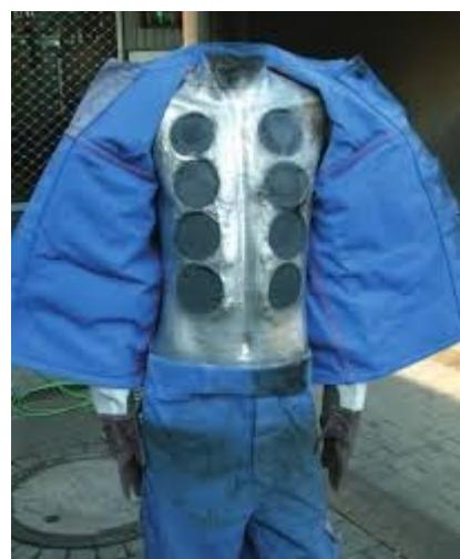
Slika 2.10. Raspored termopara na opremi RWEurotest-a. [6]
