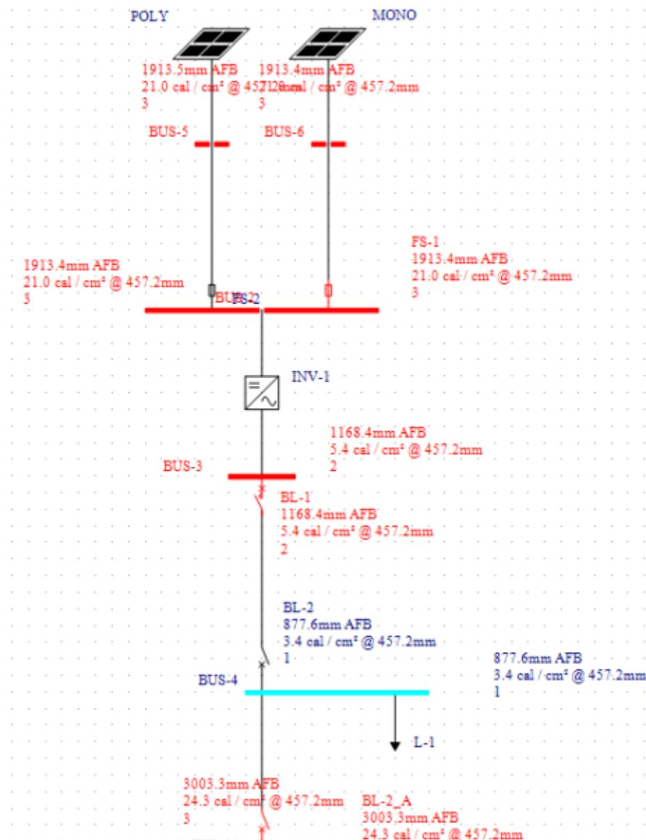
Slika 3.4. Simulacija električnog luka bez diferencijalne zaštite.
