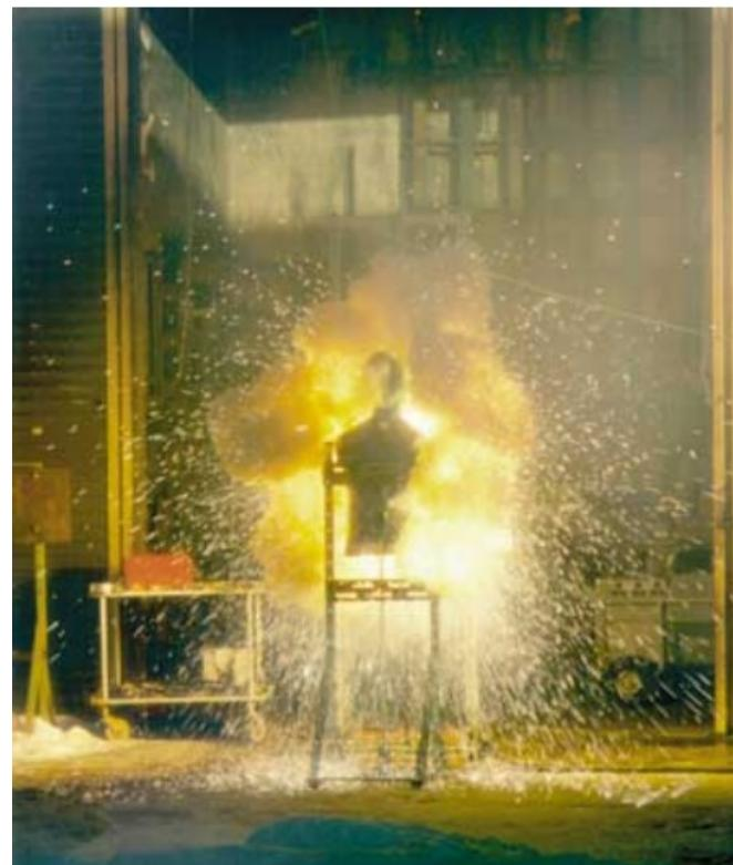
Slika 2.8. Test elektičnog luka prema CENELEC-ovom ispitnom postupku - ispitivanje radne jakne 2. klase. [3]
