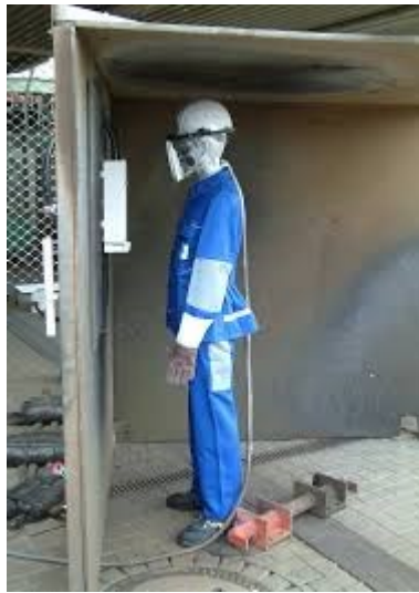
Slika 2.11. Servisna kutija tipa KH 00 100-2 i osobna zaštitna odjeća prije ispitivanja električnog luka. [5]
