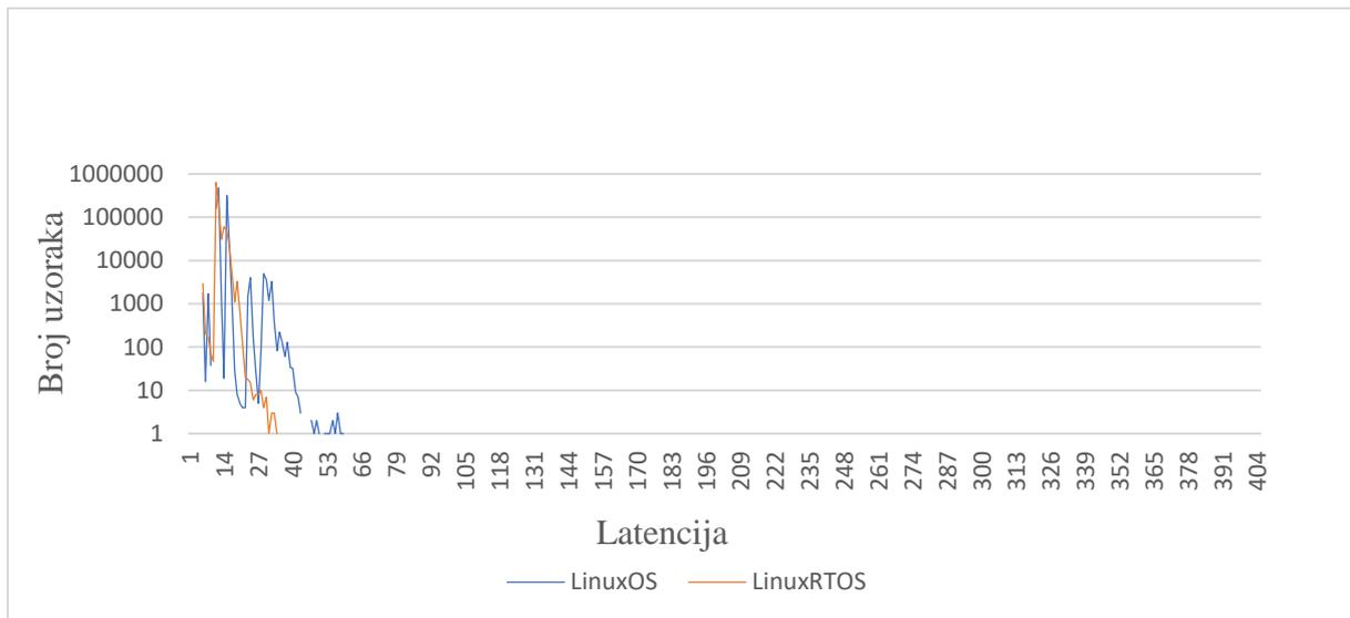
**Sl. 4.8.** Grafički prikaz rezultata mjerenja maksimalnog kašnjenja za četvrtu jezgru kod *LinuxOS* i *LinuxRTOS*.
