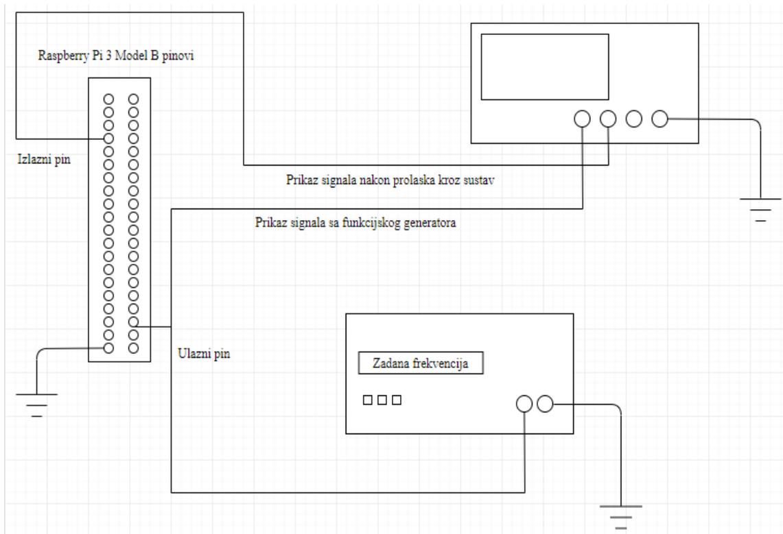
**Sl. 4.9.** Shematski prikaz povezivanja Raspberry Pi 3 Model B ploče, funkcijskog generatora i osciloskopa.
