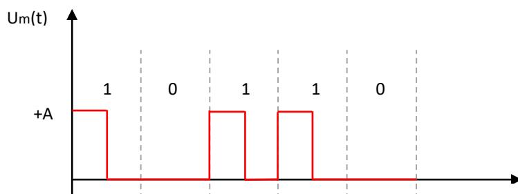
Slika 2.6. Primjer unipolarnog RETURN TO ZERO koda
