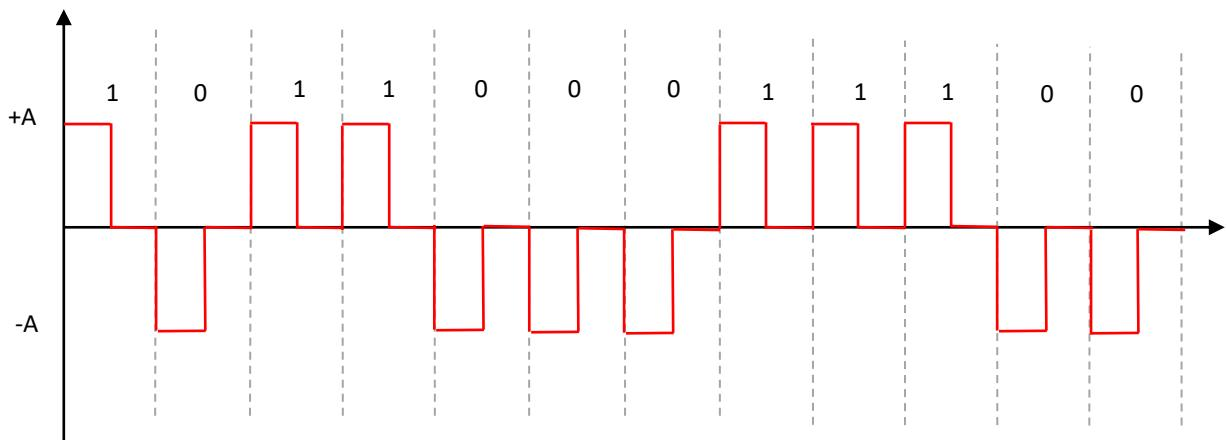
Slika 2.12. Primjer POLARNOG RETURN TO ZERO koda
