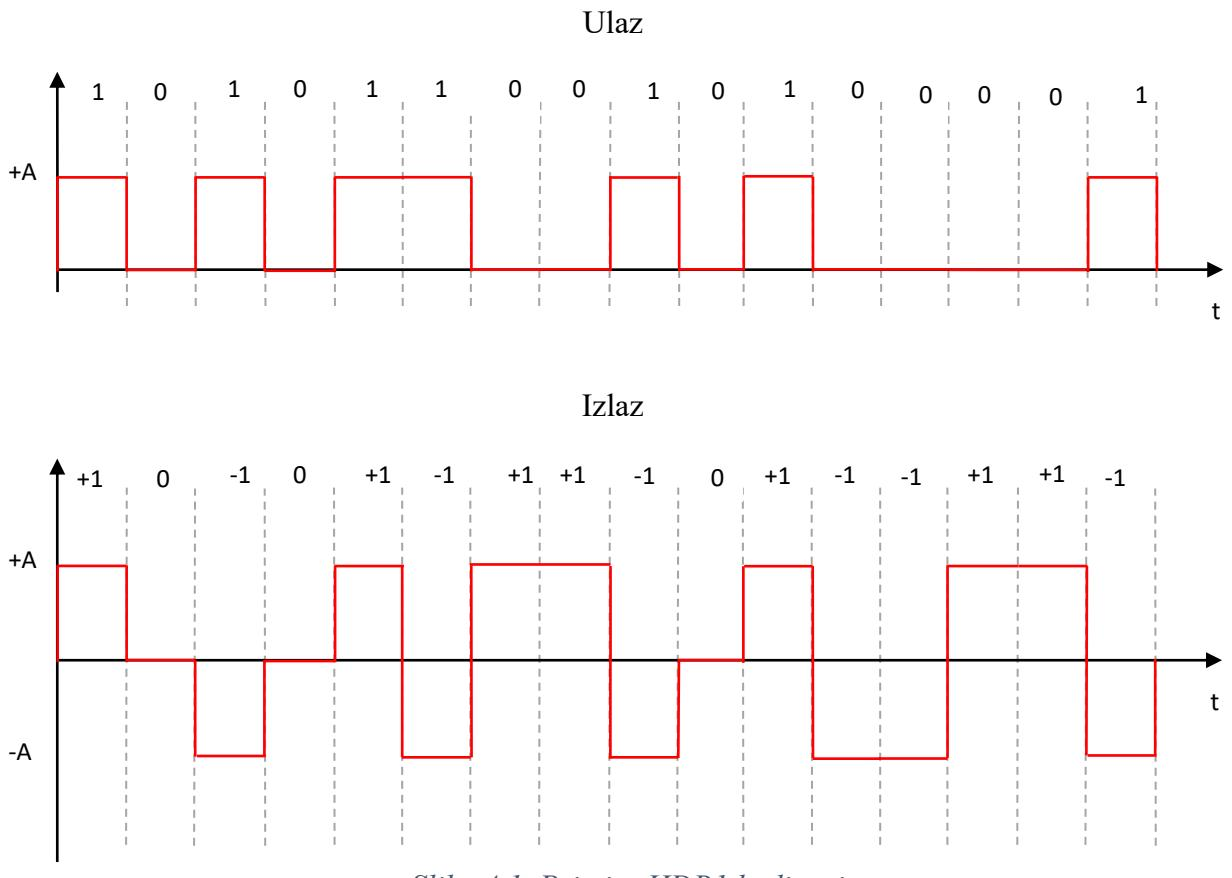
Slika 4.1. Primjer HDB1 kodiranja
