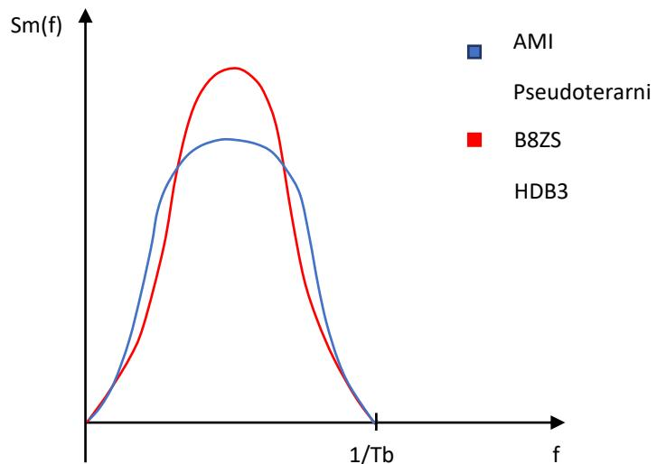
Slika 4.4. Bipolarni linijski kodovi u frekvencijskoj domeni
