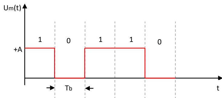
*Slika 2.5. Primjer unipolarnog NON RETURN TO ZERO koda*
