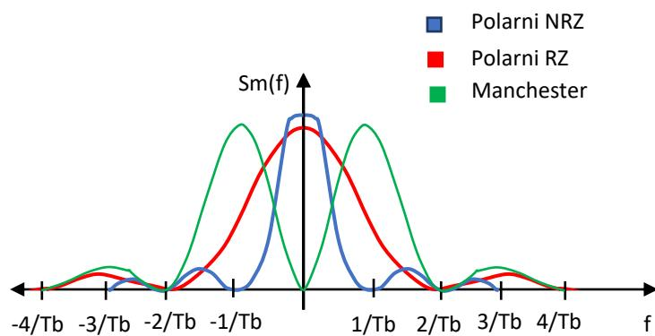
Slika 2.15. Polarni linijski kodovi u frekvencijskoj domeni
