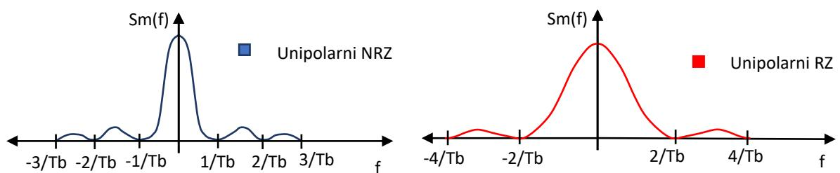
Slika 2.7. Unipolarni NRZ i unipolarni RZ u frekvencijskoj domeni
