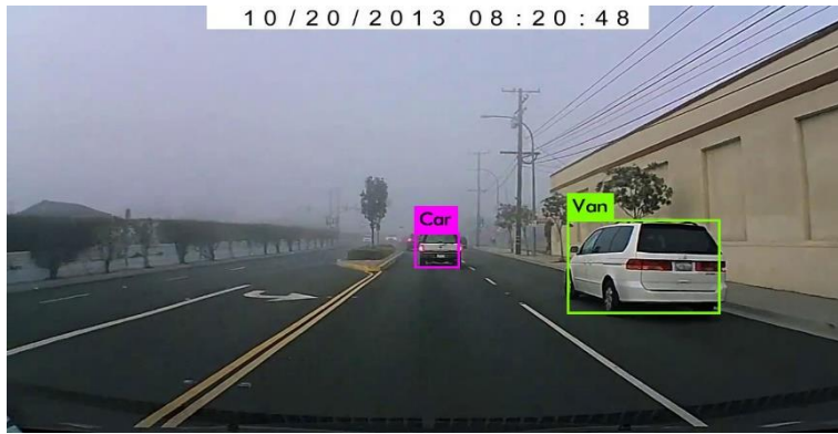
Slika 4.2. Detekcija objekata pomoću Yolo v2 algoritma po magli
