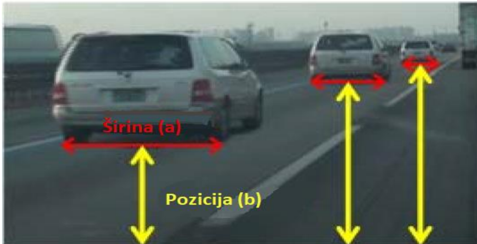
Slika 2.1. Određivanje udaljenosti (a) na osnovu širine, (b) na osnovu pozicije [3]
