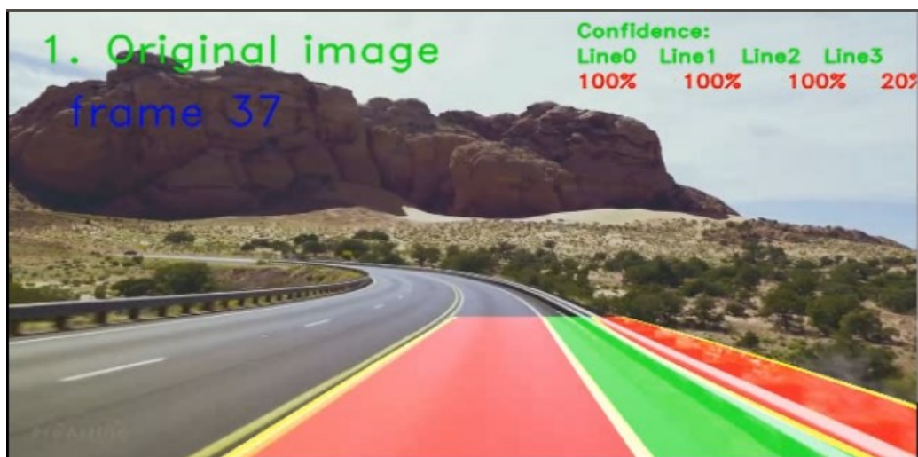
Slika. 4.7. Prikaz okvira netočne detekcije linija na cesti na 37. okviru iz snimke „Sunny_YW_Straight_Curved_NT_1.mp4“
