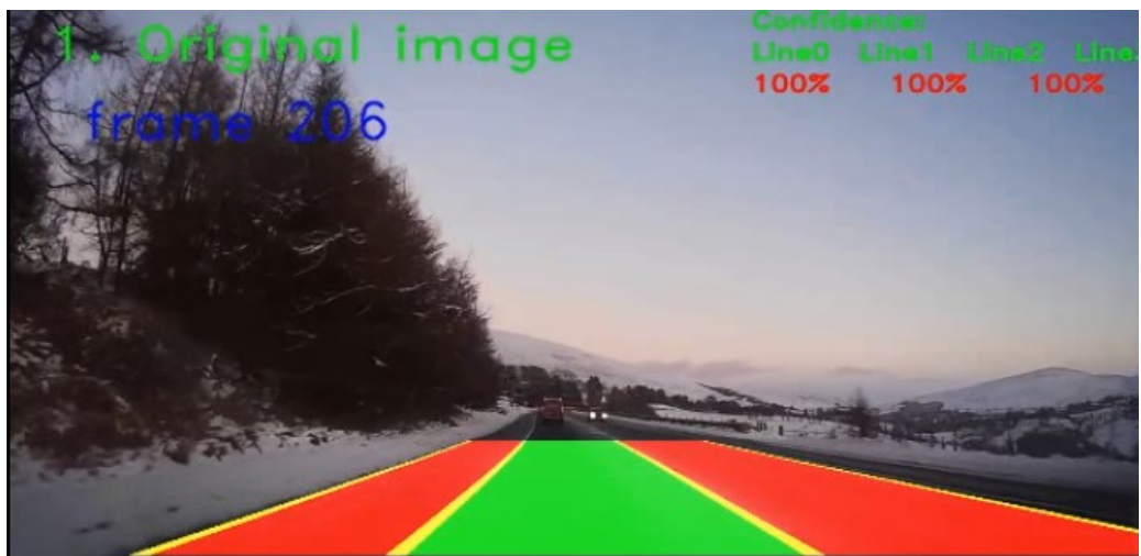
Slika. 4.4. Prikaz okvira točne detekcije linija na cesti na 206. okviru iz snimke „Snow_W_Straight_Curved_NT.mp4“
