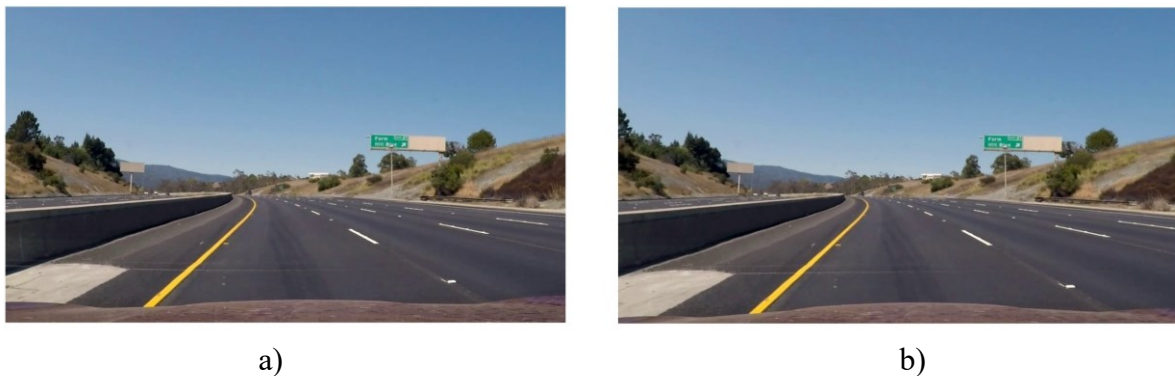
Slika. 3.5. Primjer ispravljanja izobličenja slike snimljene na prednjoj strani vozila, a) izvorna slika s izobličenjem koje unosi leća kamere, b) ispravljena slika bez izobličenja nakon postupka kalibracije kamere.
