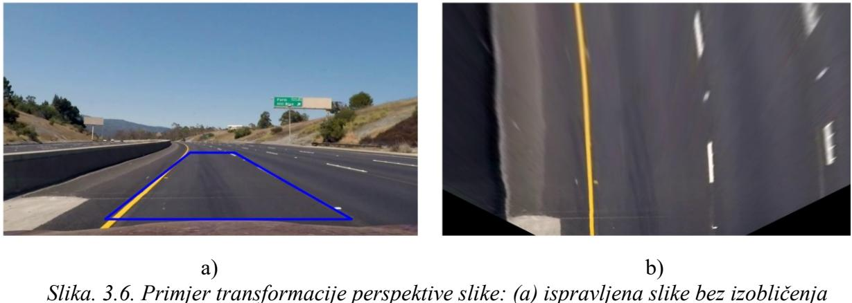
*Slika. 3.6. Primjer transformacije perspektive slike: (a) ispravljena slika bez izobličenja kojeg unosi kamera, s označenim ROI-jem, (b) ROI sa slike (a) iz ptičje perspektive, nakon provedene transformacije perspektive*
