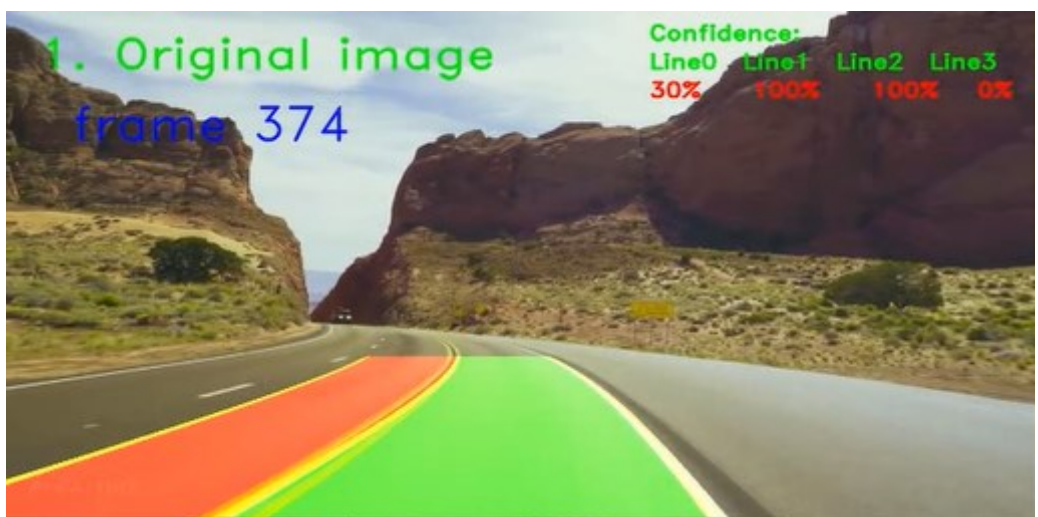
Slika. 4.6. Prikaz okvira točne detekcije linija na cesti na 374. okviru iz snimke „Sunny_YW_Straight_Curved_NT_1.mp4“
