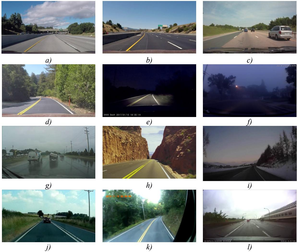
Slika. 4.1. Prikaz jednog izdvojenog okvira korištenih u testiranju točnosti broja detektiranih linija voznih traka u odnosu na stvarni broj linija voznih traka na cesti za video sekvencu
