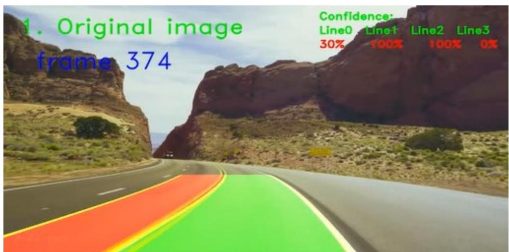
Slika. 4.6. Prikaz okvira točne detekcije linija na 374. okviru iz snimke „Sunny\_YW\_Straight\_Curved\_NT\_1.mp4“
