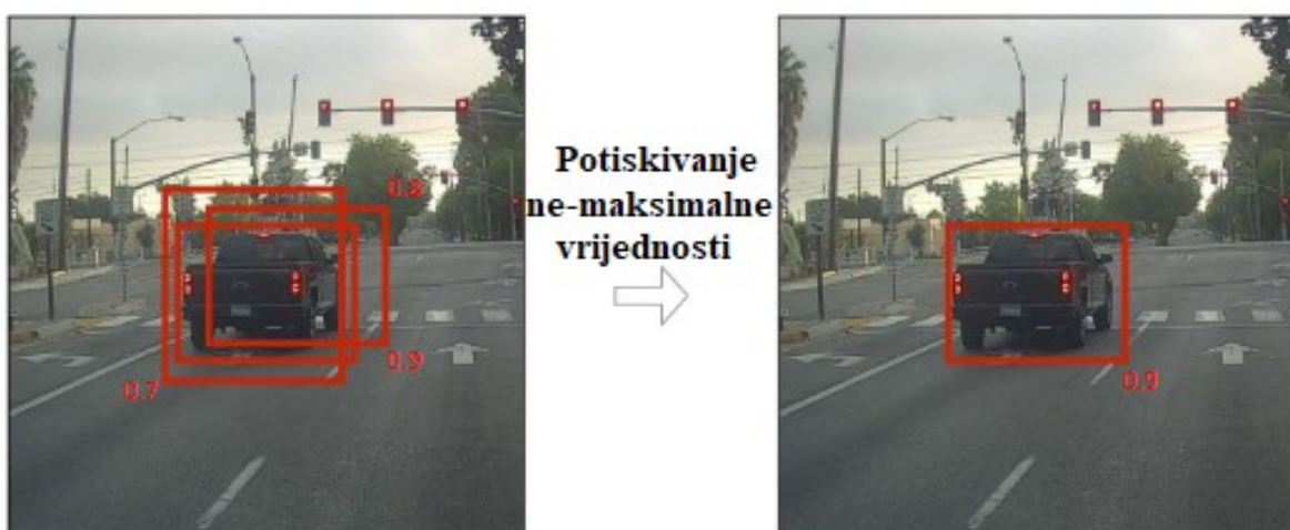
SI. 2.7. Primjer potiskivanja ne-maksimalne vrijednosti [11]
