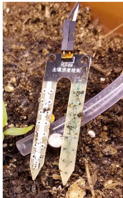
Slika 2.15. – prikaz oksidiranih elektroda rezistivnog senzora [21]
