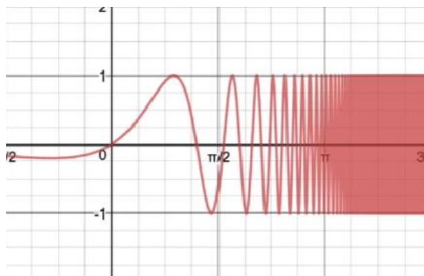
Slika 2.1. – Prikaz „chirp spread spectrum“ signala [10]
