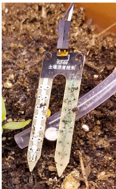
Slika 2.15. – prikaz oksidiranih elektroda rezistivnog senzora [21]
