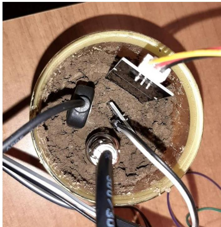
Slika 4.2. – Prikaz senzora uronjenih u zemlju prilikom testiranja
