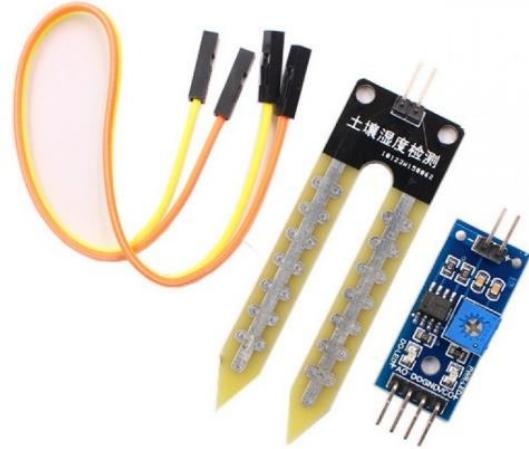
Slika 2.8. – Rezistivni senzor bez zaštite [15]
