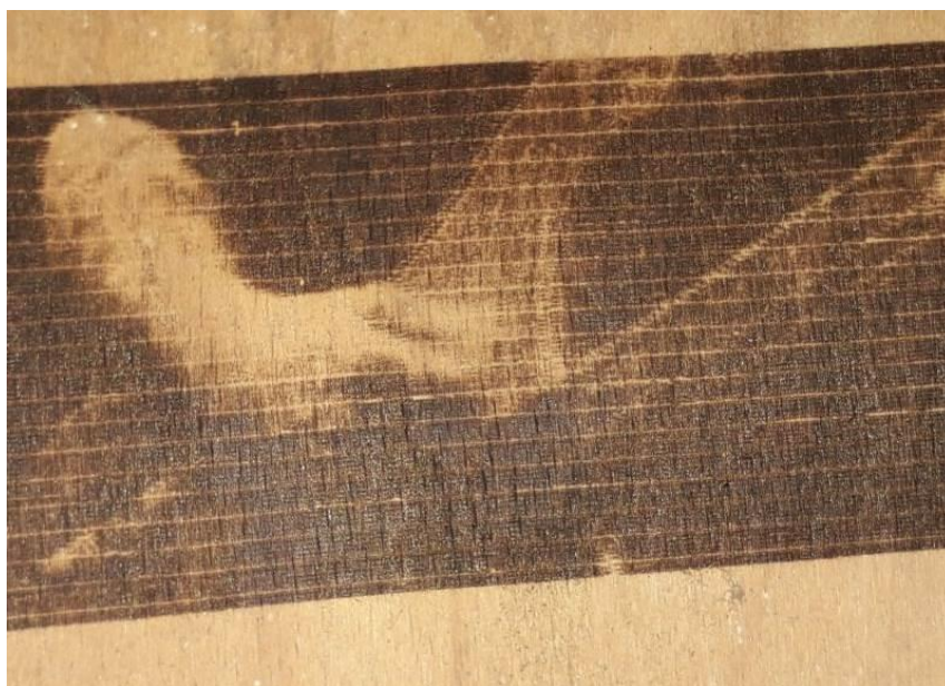
Slika 4.5 Ispis na drvo niskom brzinom
