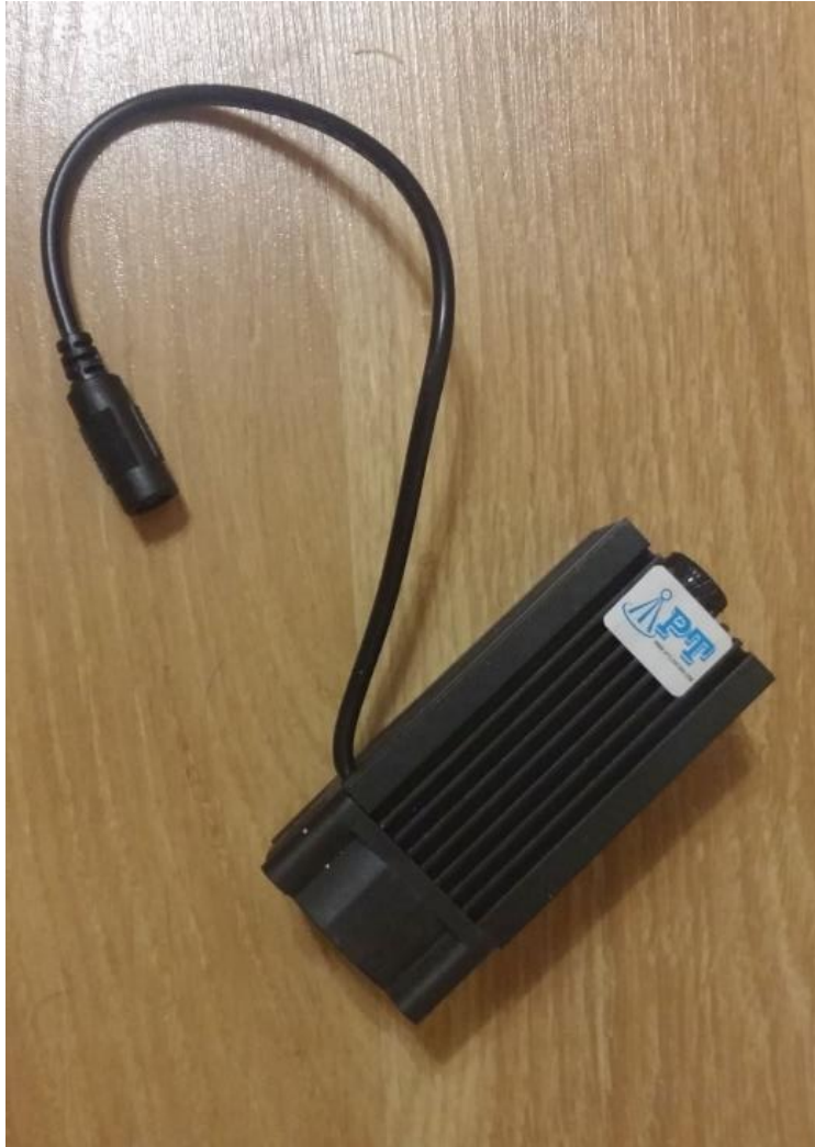
Slika 3.10: Laser 2500 mW, 445 nm
