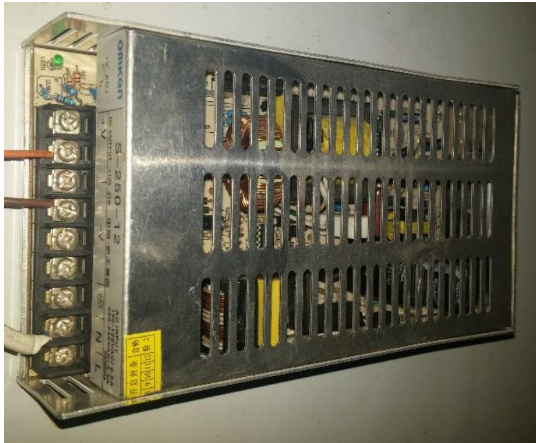
Slika 3.6.: strujno napajanje od 250 W, 12V
