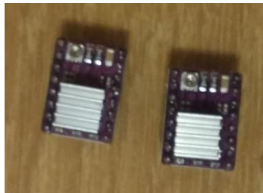
Slika 3.13:Driveri za koračne motore
