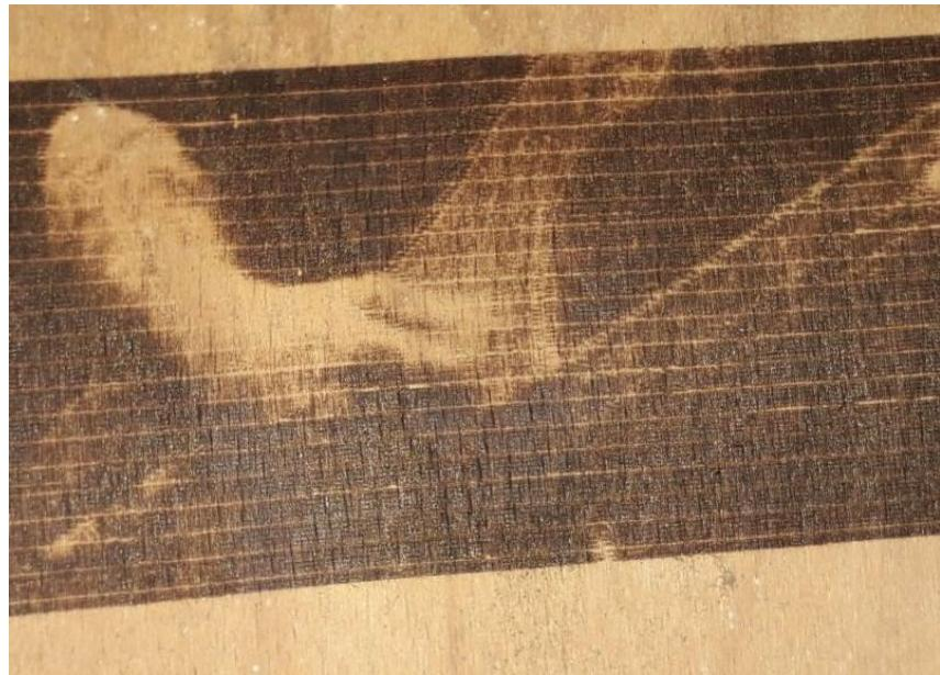
*Slika 4.5 Ispis na drvo niskom brzinom*
