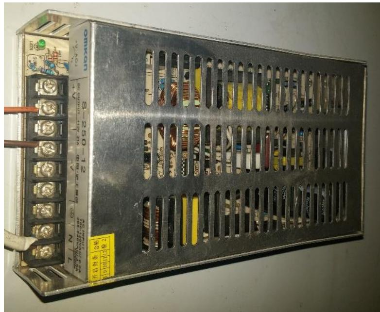
Slika 3.6.: strujno napajanje od 250 W, 12V
