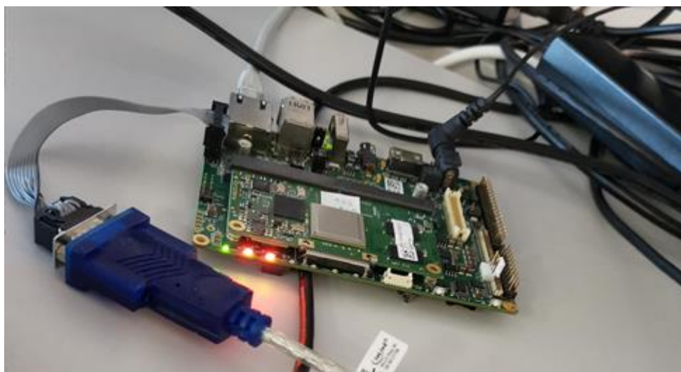
Slika 5.1. Apalis iMX6 SOC povezan na Ixora razvojnu ploču
