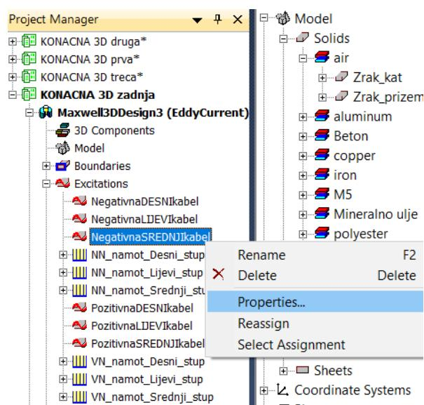
**Slika 5.31.** Prvi korak za namještanje nesimetričnog opterećenja
