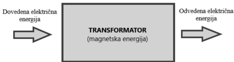
**Slika 2.7.** Pretvorba energije u transformatoru
