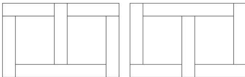
**Slika 2.13.** Slaganje limova trofaznog transformatora
