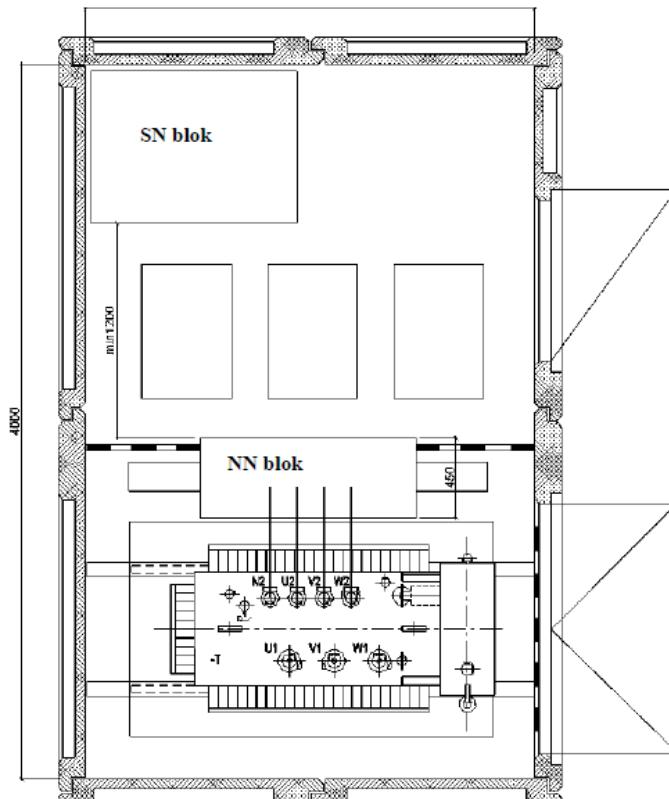
**Slika 2.5.** Raspored unutar distributivne trafostanice TS 10(20)/0,4 kV
