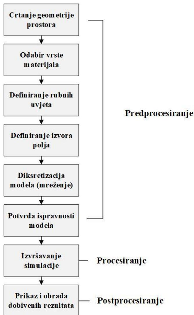
**Slika 3.3.** Dijagram toka radnji kod metode konačnih elemenata
