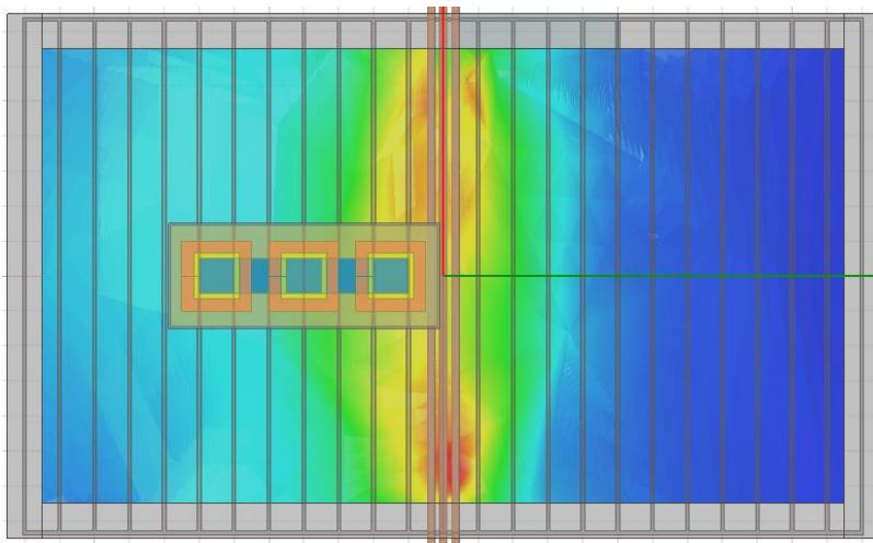
**Slika 5.24.** Prikaz intenziteta magnetskog polja u trećoj simulaciji
