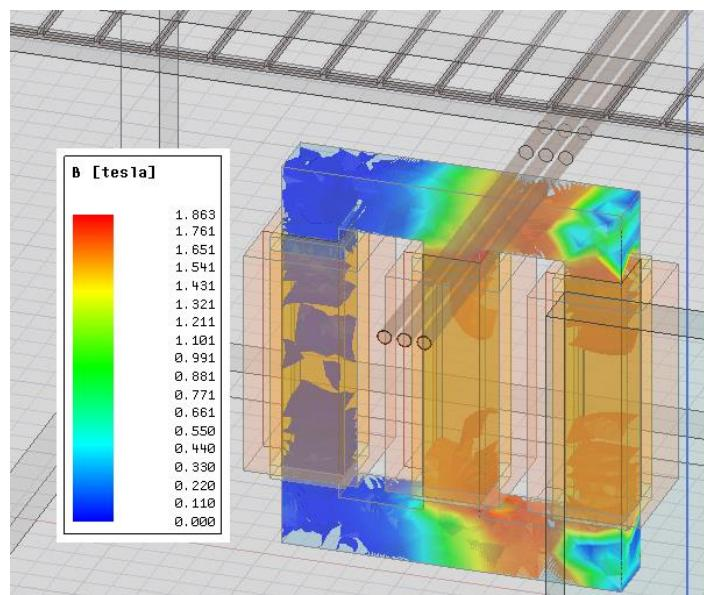
**Slika 5.21.** Intenzitet magnetske indukcije u jezgri transformatora
