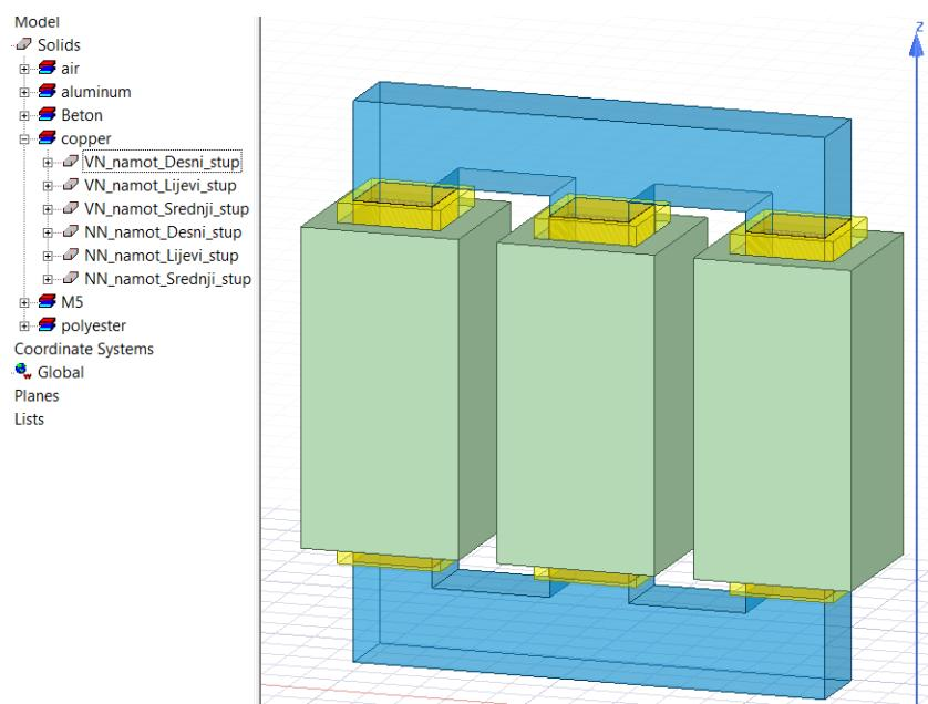
**Slika 4.38.** Kreiran kompletni model aktivnog dijela transformatora
