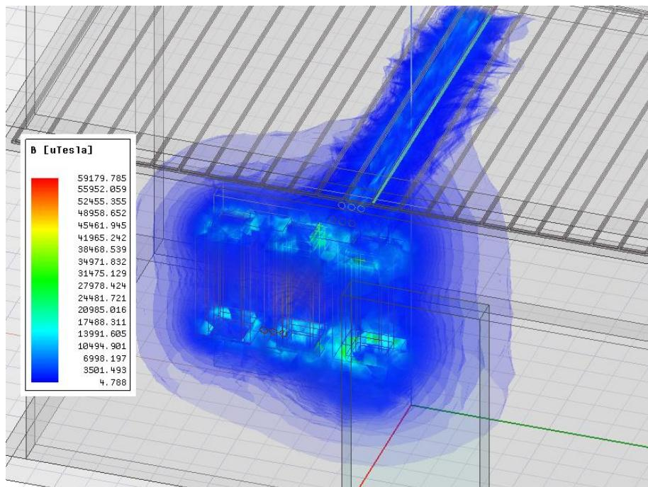
**Slika 5.25.** Prikaz intenziteta magnetske indukcije u prizemlju zgrade za drugu simulaciju
