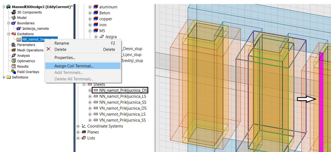
Slika 4.53. Postupak dodavanja broja zavoja u NN namotu na desnom stupu
