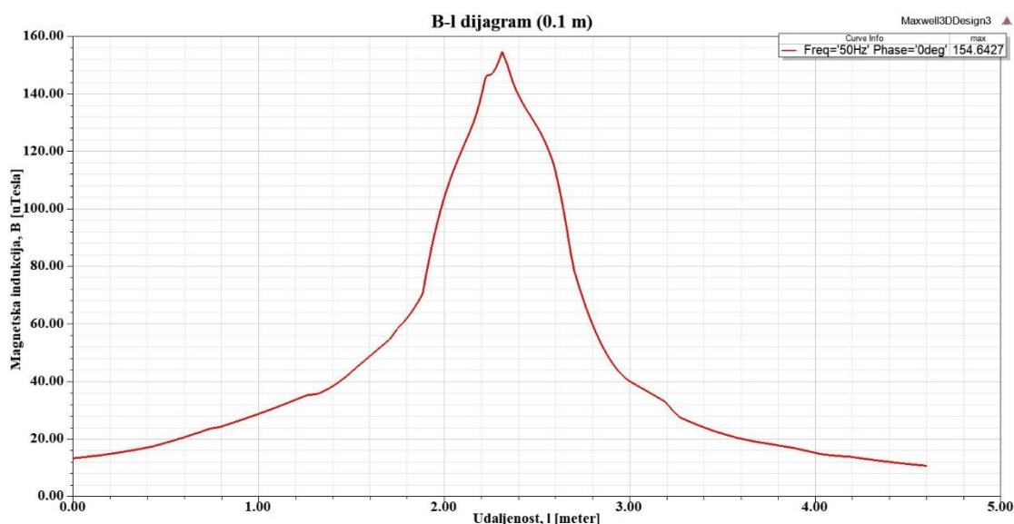
**Slika 5.17.** Ovisnost magnetske indukcije  $B$  o udaljenosti  $l$ , na  $0.1 \text{ m}$  od stropa
