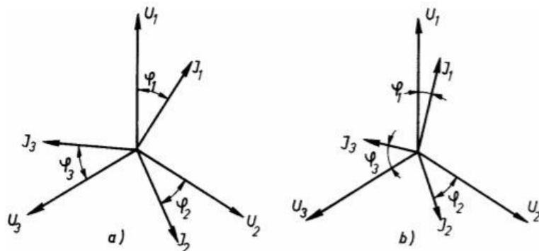
**Slika 2.22.** Opterećenje transformatora: a) simetrično i b) nesimetrično
