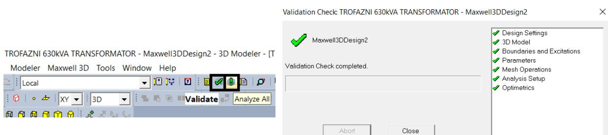
**Slika 4.73.** Provjera valjanosti kreiranog modela i pokretanje simulacije
