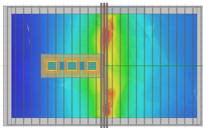
**Slika 5.33.** Prikaz intenziteta magnetskog polja u četvrtoj simulaciji
