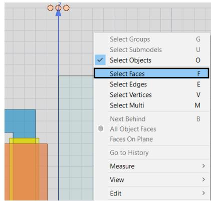
**Slika 4.55.** Promjena na površinsko označavanje objekta
