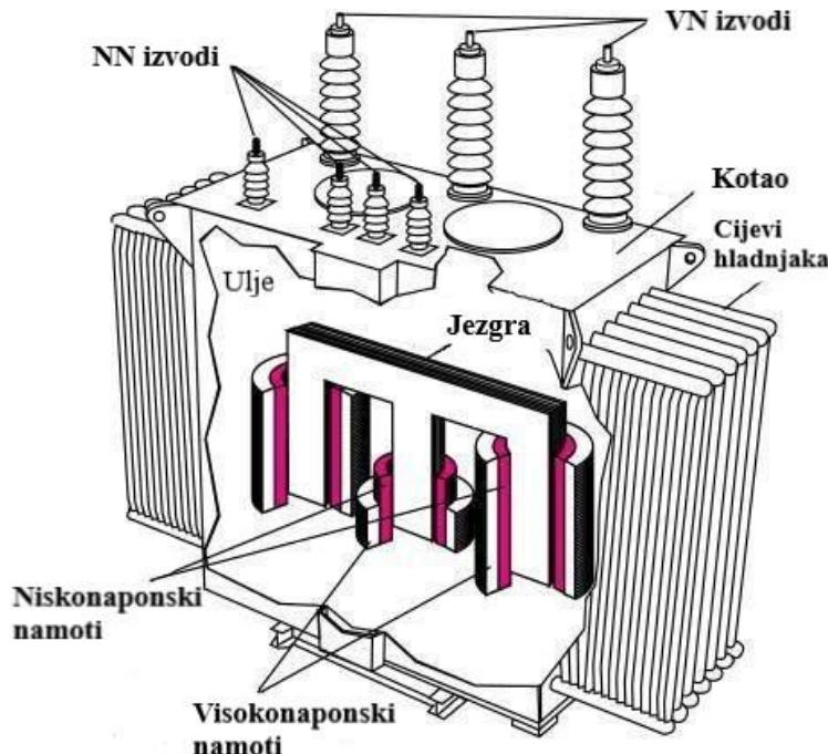
**Slika 2.9.** Dijelovi transformatora
