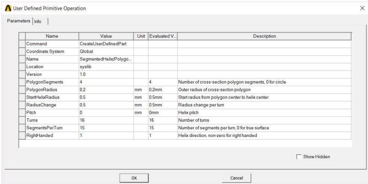
**Slika 4.3.** Unos parametara za crtanje kružne zavojnice
