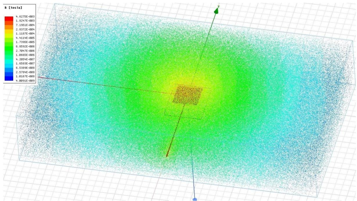
**Slika 5.32.** Prikaz magnetske indukcije za kvadratnu topologiju zavojnice
