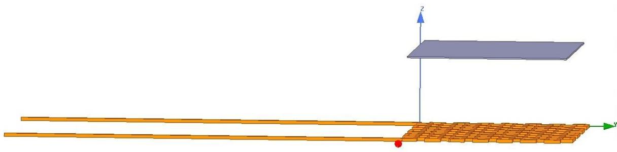
**Slika 5.14.** Udaljenost senzora i metalne vrpce 10 mm
