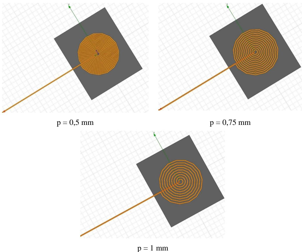
**Slika 5.1.** Prikaz kružnih topologija senzora za različiti udaljenost između zavoja
