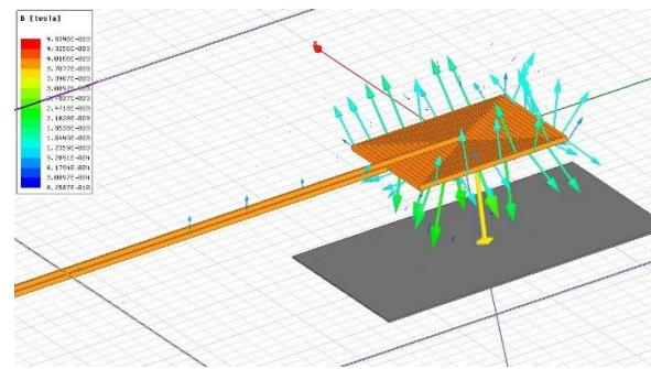
**Slika 5.28.** Vektori magnetske indukcije kvadratne zavojnice za udaljenost metalne vrpce 10 mm
