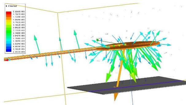
**Slika 5.22.** Vektori magnetske indukcije kružne zavojnice za udaljenost metalne vrpce
