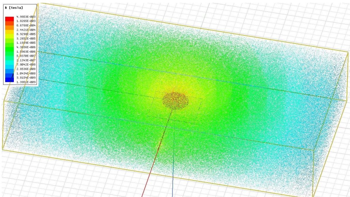
**Slika 5.29.** Prikaz magnetske indukcije za kružnu topologiju zavojnice
