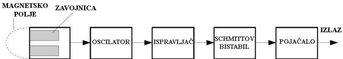
**Slika 2.4.** Struktura induktivnog senzora
