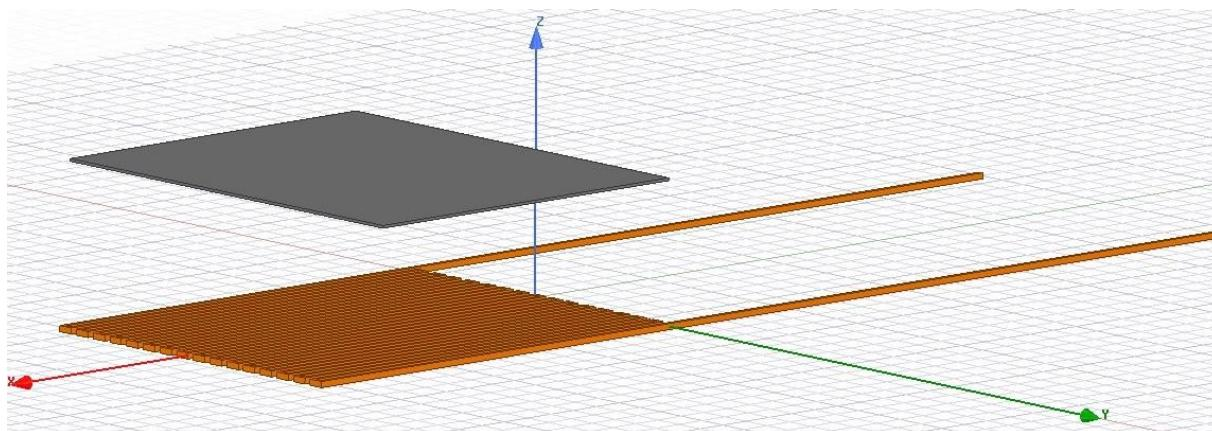
**Slika 5.9.** Udaljenost senzora i metalne vrpce 10 mm
