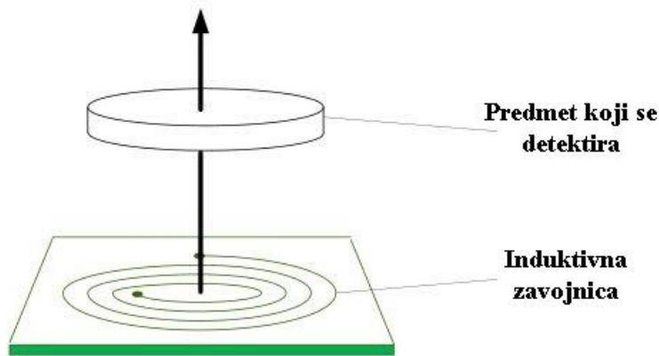
**Slika 2.3.** Kružna zavojnica i predmet koji se ortogonalno detektira
