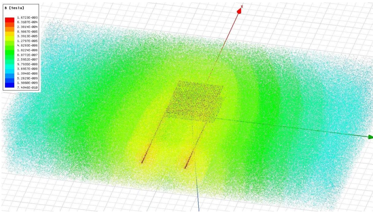
**Slika 5.30.** Prikaz magnetske indukcije za meandar topologiju zavojnice
