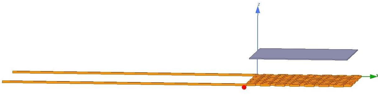
**Slika 5.13.** Udaljenost senzora i metalne vrpce 5 mm
