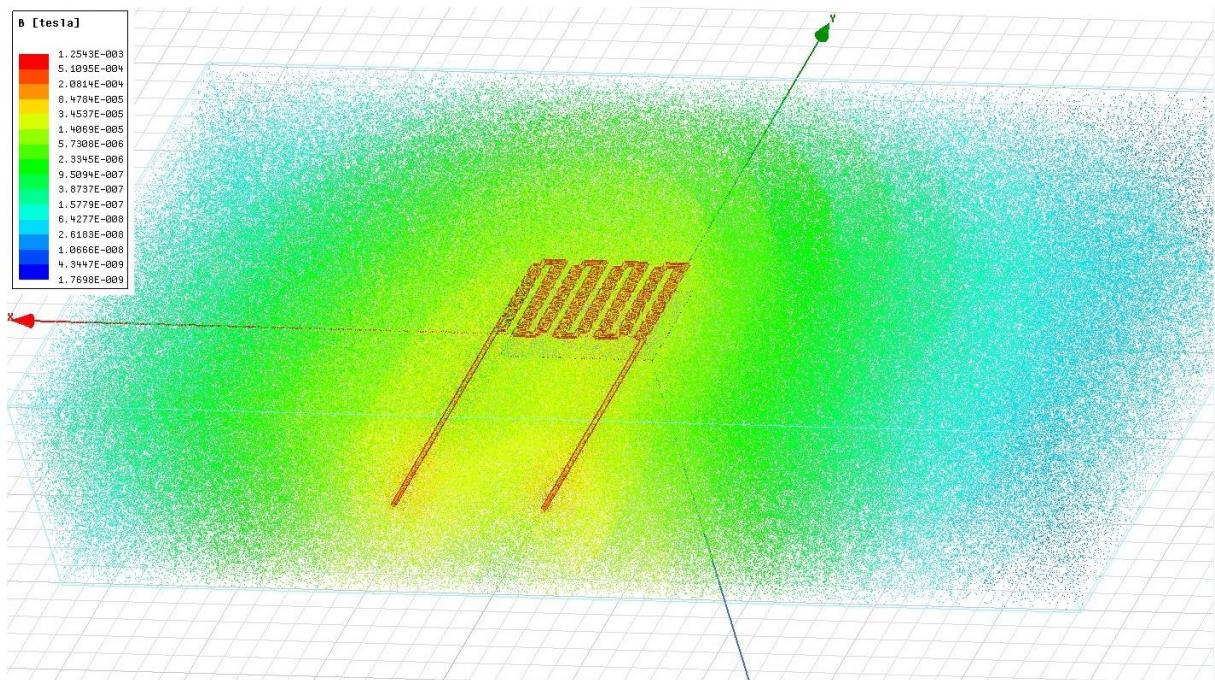
**Slika 5.31.** Prikaz magnetske indukcije za mrežastu topologiju zavojnice
