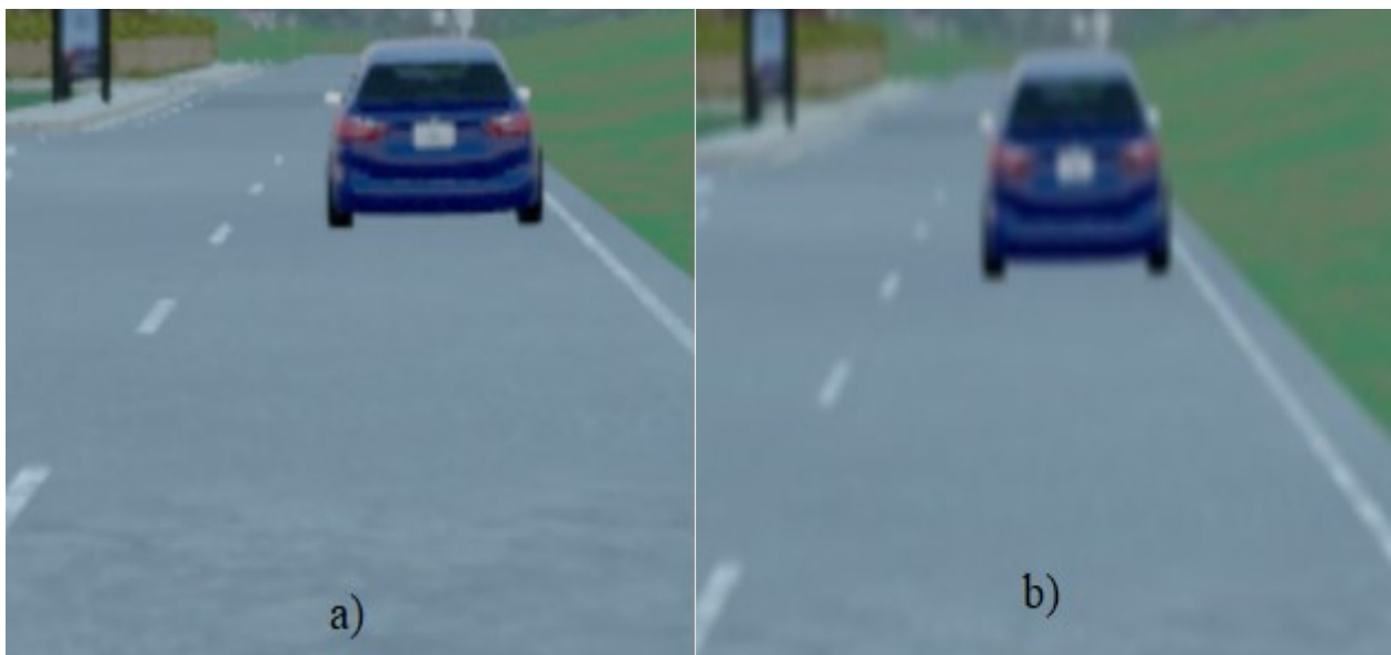
Slika 3.6. Prikaz ulaznog video okvira (a) i video okvira nad kojim je primijenjen Gaussov filtar dimenzija konvolucijske matrice 3x3 (b).
