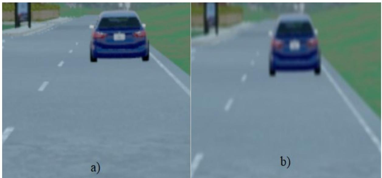
Slika 3.6. Prikaz ulaznog video okvira (a) i video okvira nad kojim je primijenjen *Gaussov* filter dimenzija konvolucijske matrice 3x3 (b).
