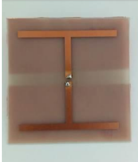
Slika 5.21. Tip-3 s tri bakarne trake
