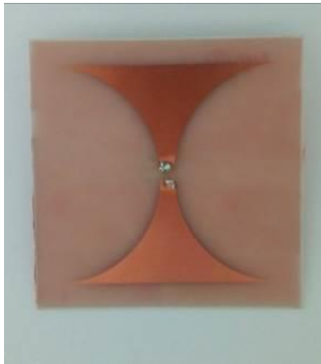
Slika 4.26- Tip-2 s pet bakarnih traka
