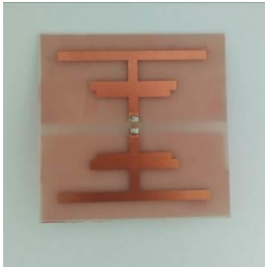
Slika 3.21. Tip-1 s četiri bakarne trake
