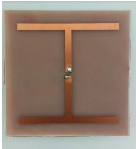
Slika 5.26. Tip-3 s pet bakarnih traka
