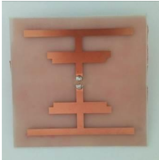
Slika 3.26. Tip-1 s pet bakarnih traka
