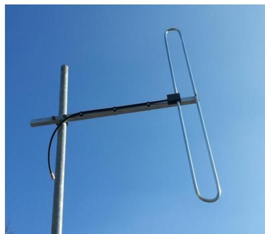
Slika 2.5. Savijeni-dipol antena
