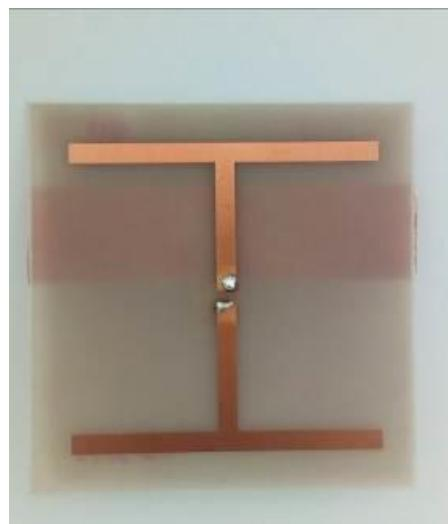
Slika 5.6. Tip-3 s jednom bakarnom trakom
