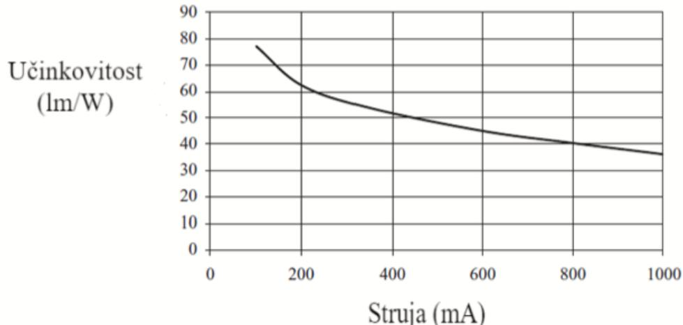
Slika 3. 5. Učinkovitost naspram struje koju provodi dioda [2].
