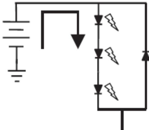
Slika 3. 2. Diode u anti – paraleli s LED [2]
