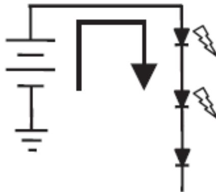
Slika 3. 1. Obična ispravljačka diode u seriji sa LED [2]
