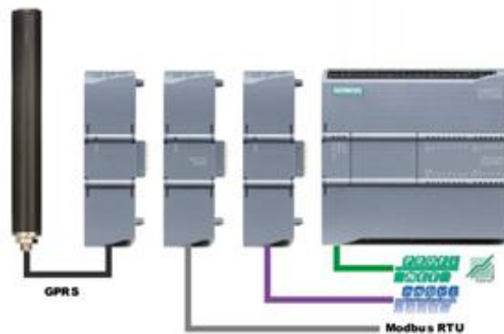
Slika 3.12. Mogućnosti komunikacije putem komunikacijskih modula [34]
