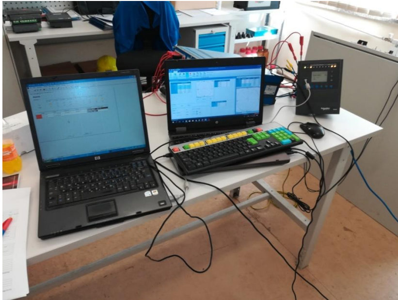
Slika 6.1 Oprema korištena u procesu parametriranja i ispitivanja zaštitnog releja
