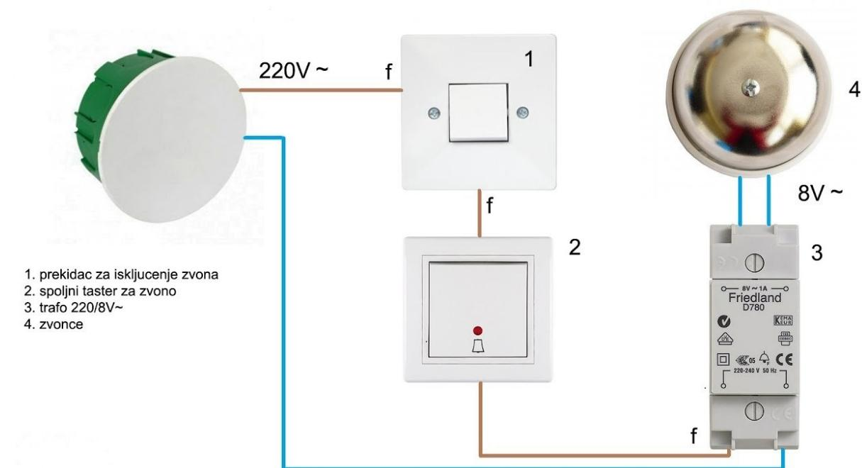
Slika 2.7: Spajanje električnog zvonca na mrežu
