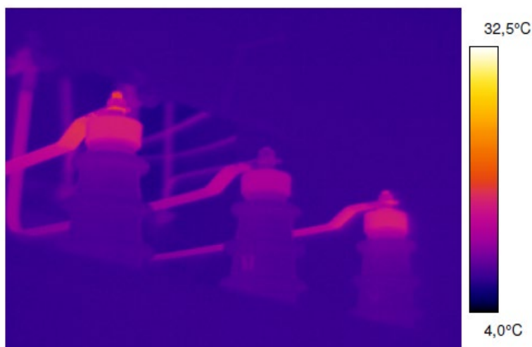
Slika 7.2. Odabir preširokog mjernog opsega (level/span), [9]
