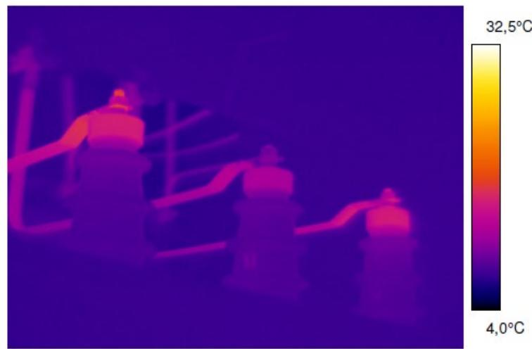
**Slika 7.2.** Odabir preširokog mjernog opsega (level/span), [9]
