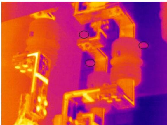
**Slika 7.16.** IR slika provodne ploče od prokroma
