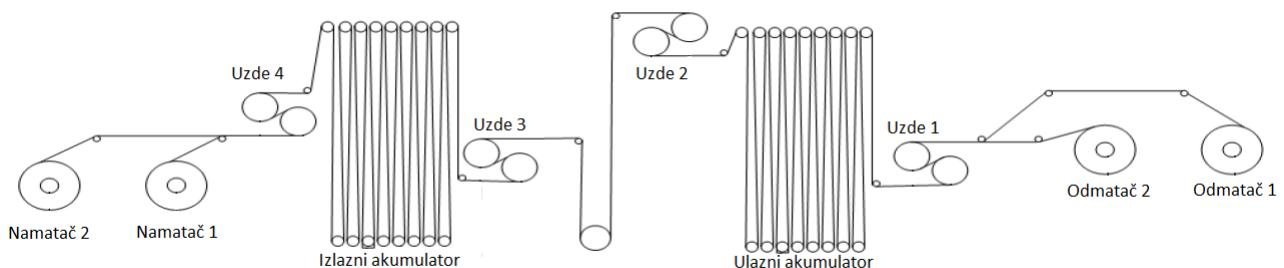
**Slika 2.1.** Pojednostavljeni prikaz postrojenja za obradu čelične trake. [5]
