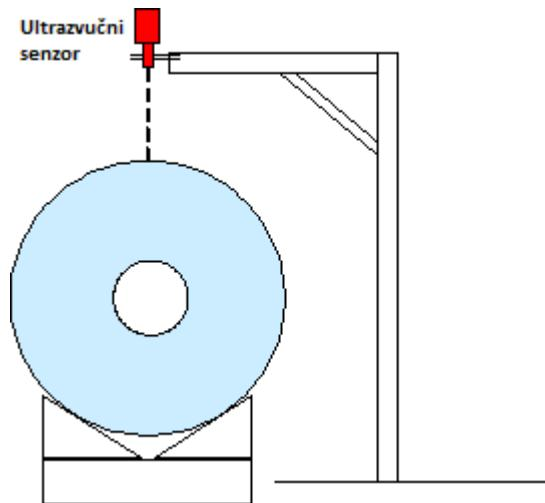
**Slika 2.7.** Sustav za mjerjenje promjera namota.
