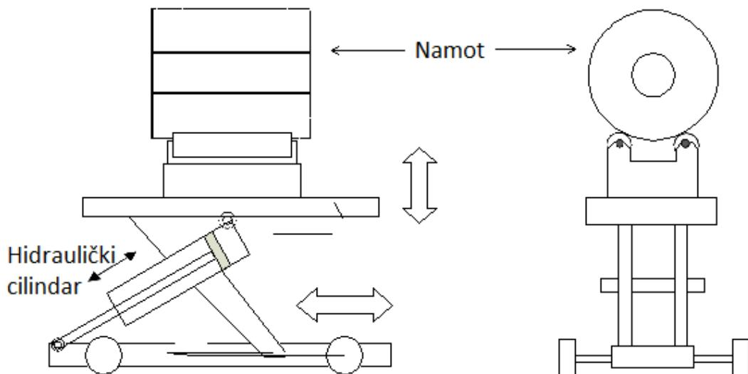
Slika 2.5. Transportna kolica za prijenos namota (*Coil car*).
