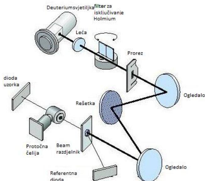
Slika 3.16. UV apsorpcijski detektor i njegovi dijelovi [22]
