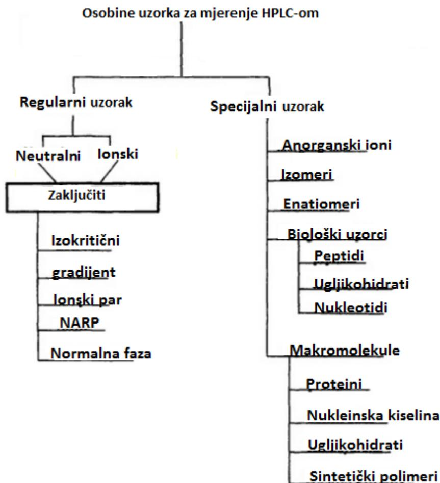
*Slika 3.22. Određivanje uzorka za HPLC*
