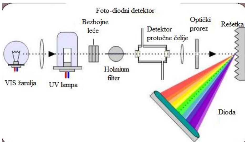
Slika 3.18. Foto-diodni detektor i njegov princip rada [21]
