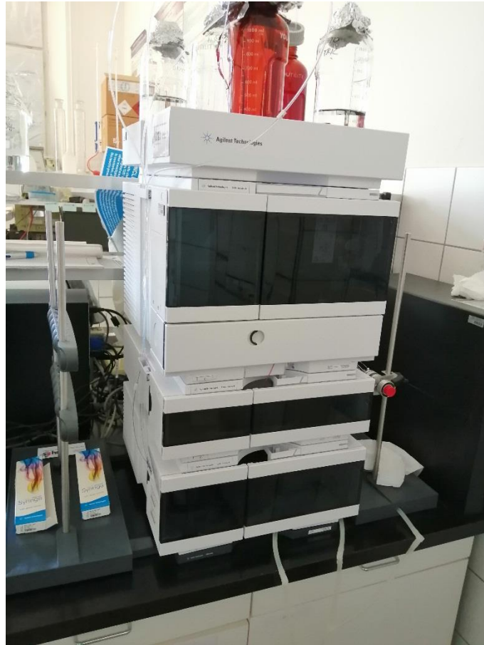
Slika 3.2. HPLC uređaj Infinity II 1260 Prehrambeno-tehnološkog fakulteta u Osijeku
