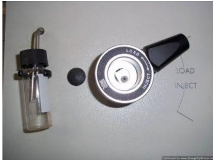
Slika 3.7. Rheodyne ubrizgavač ili petlja za ubrizgavanje kao HPLC sustav za ubrizgavanje[11]
