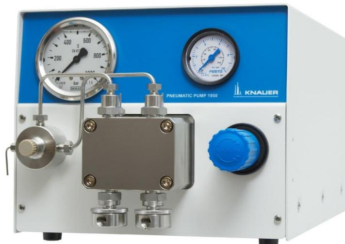
*Slika 3.5. pneumatska pumpa za HPLC uređaj [10]*
