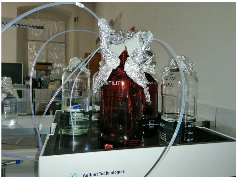
*Slika 5.5. Tekućine pomoću kojih se HPLC uređaj čisti*
