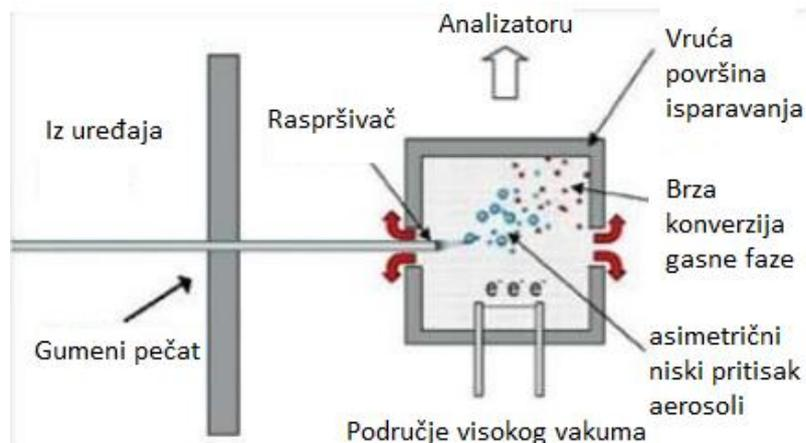
Slika 3.20. Maseni spektrometar kao detektor HPLC-a [21]
