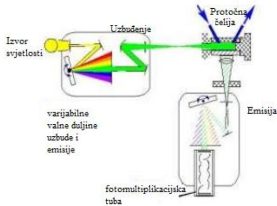
Slika 3.17. Detektor fluorescentnih zraka i njegov princip rada [21]
