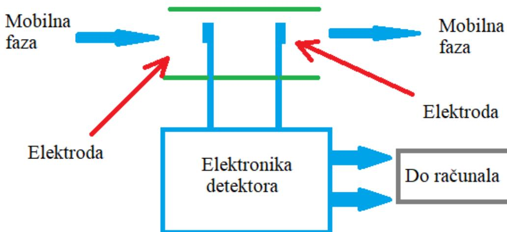
Slika 3.21. Detektor električne vodljivosti i njegov princip rada [21]
