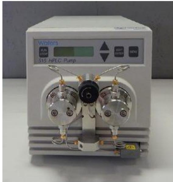
*Slika 3.4. klipna pumpa za HPLC uređaj [8]*
