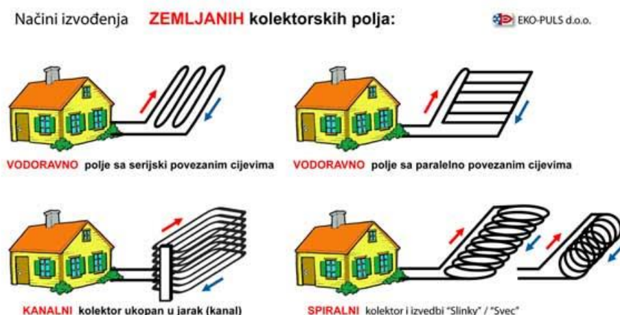
Slika 5.4. Vrste horizontalnih sustava [15]
