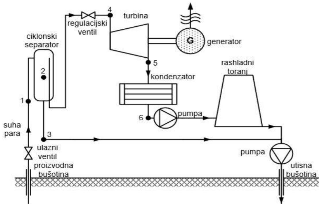
Slika 4.2. Pojednostavljena shema elektrane sa separiranjem pare [2]
