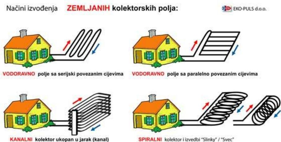
Slika 5.4. Vrste horizontalnih sustava [15]
