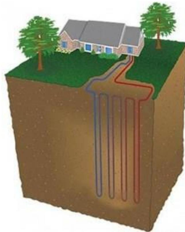
*Slika 5.5. Vertikalni sustav*
