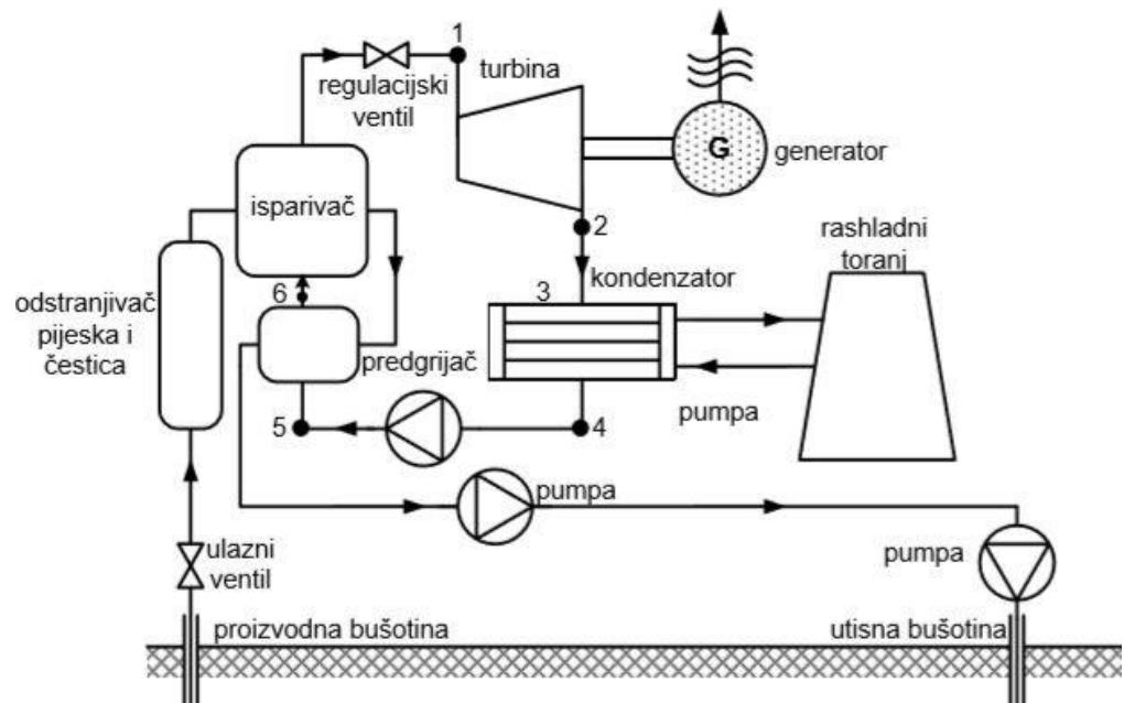
*Slika 4.3. Pojednostavljena shema elektrane s binarnim ciklusom [2]*
