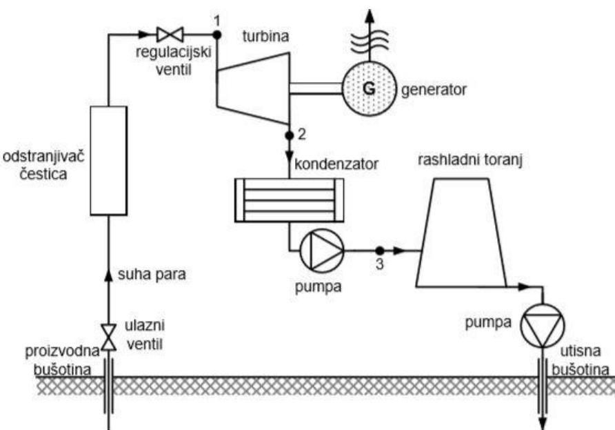
Slika 4.1. Pojednostavljena shema elektrane na suhu paru [2]
