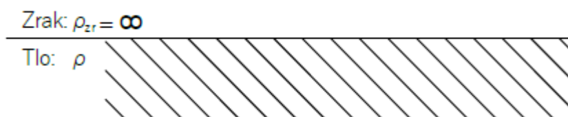
Slika 2.12. Model jednoslojnog tla [4]
