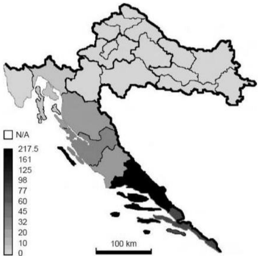
Slika 1.4. Maksimalna snaga potencijalnih vjetroelektrana [MW] [3]
