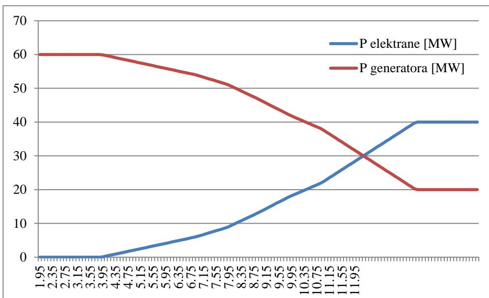
Slika 1.14. Ovisnost proizvodnje generatora o proizvodnji vjetroelektrane
