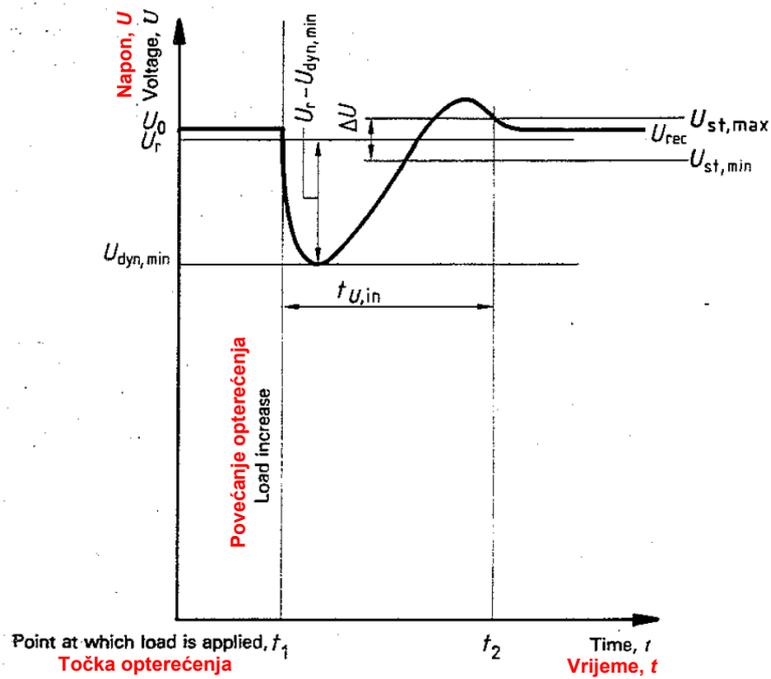
Slika 3.6. Prijelazna karakteristika napona nakon naglog opterećenja [15]
