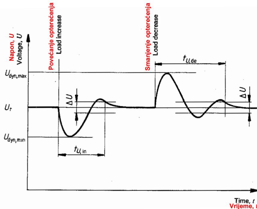
Slika 3.5. Dinamičke karakteristike napona pri naglim promjenama opterećenja [15]
