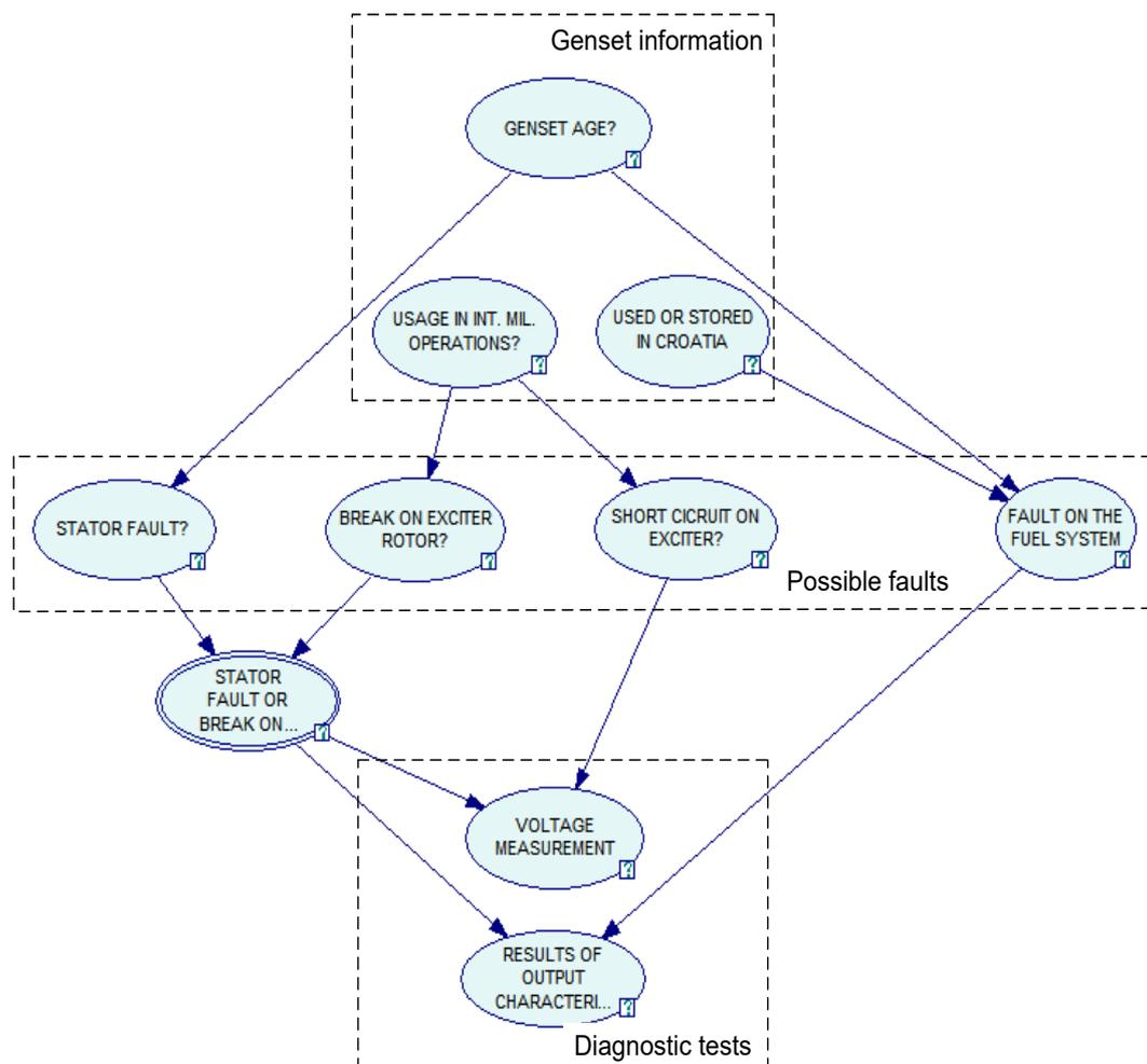
Slika 4.1. Bayesova mreža za detekciju kvara na elektroagregatu
