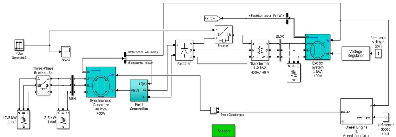
Slika 4.6. Osnovni model za simulaciju kvarova generatora
