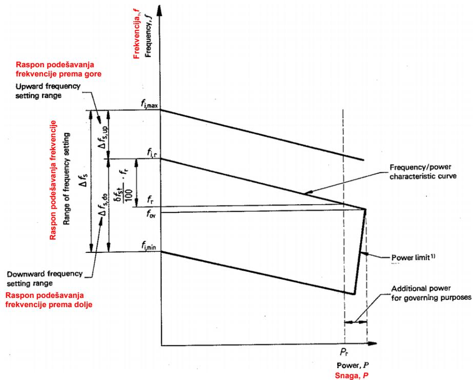
Slika 3.1. Ovisnost frekvencije o opterećenju generatora [15]
