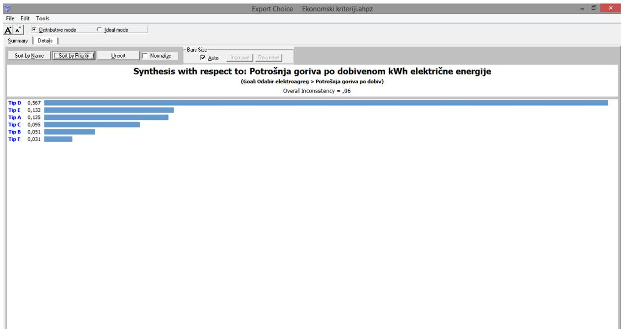
Slika 5.6. Prioriteti najoptimalnijih tipova elektroagregata prema potrošnji goriva
