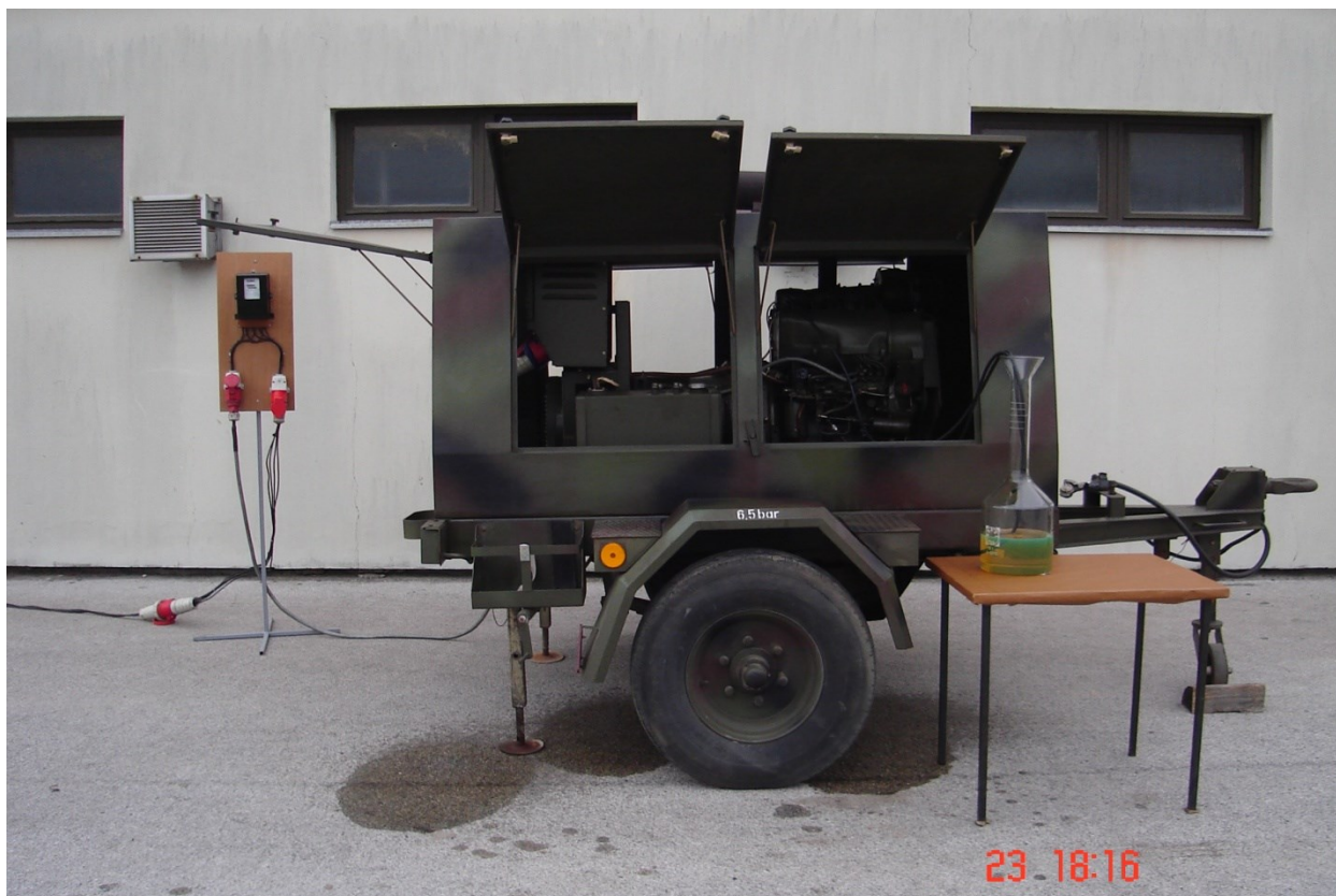
Slika 3.8. Ispitivanje elektroagregata za potrebe kategorizacije
