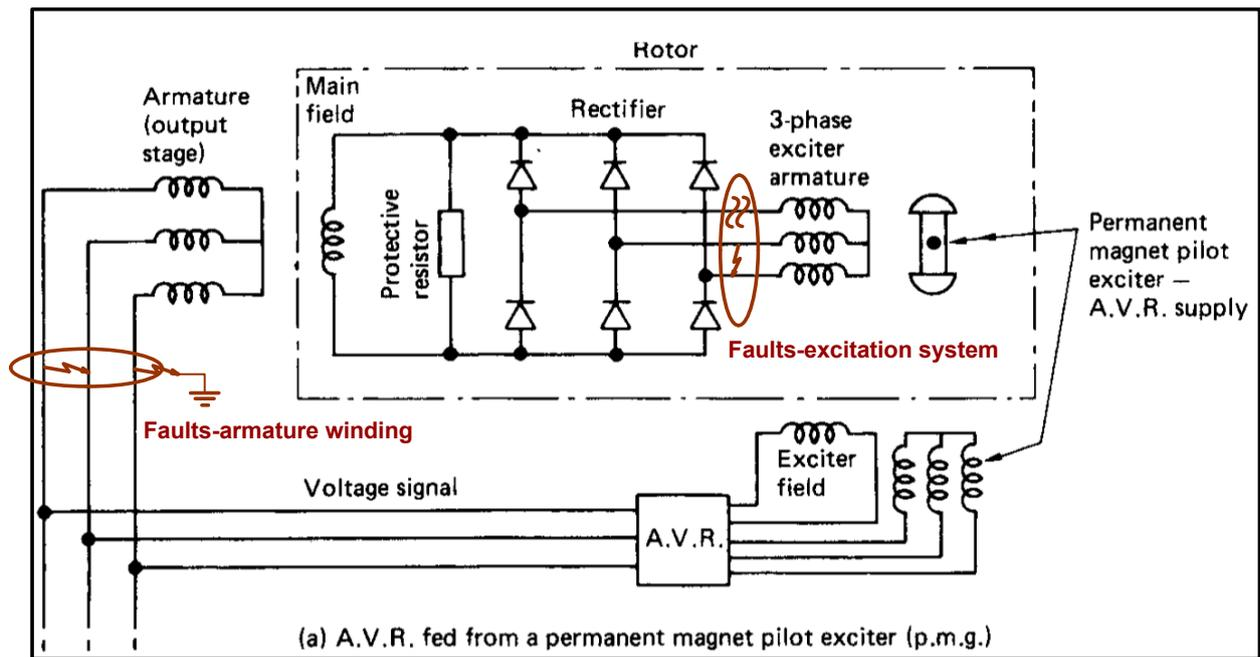
Slika 4.3. Shema sinkronog beskontaktnog generatora s razmatranim kvarovima
