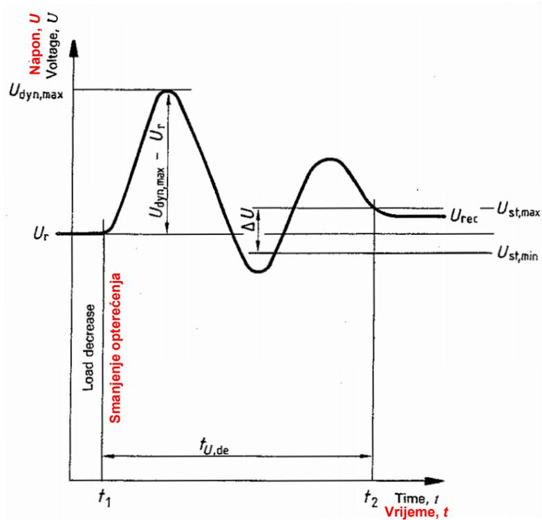
Slika 3.7. Prijelazna karakteristika napona nakon naglog rasterećenja [15]
