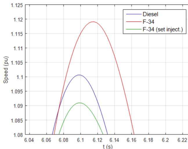
Slika 3.22. Nadvišenja brzine vrtnje prije i nakon podešavanja sustava ubrizgavanja goriva
