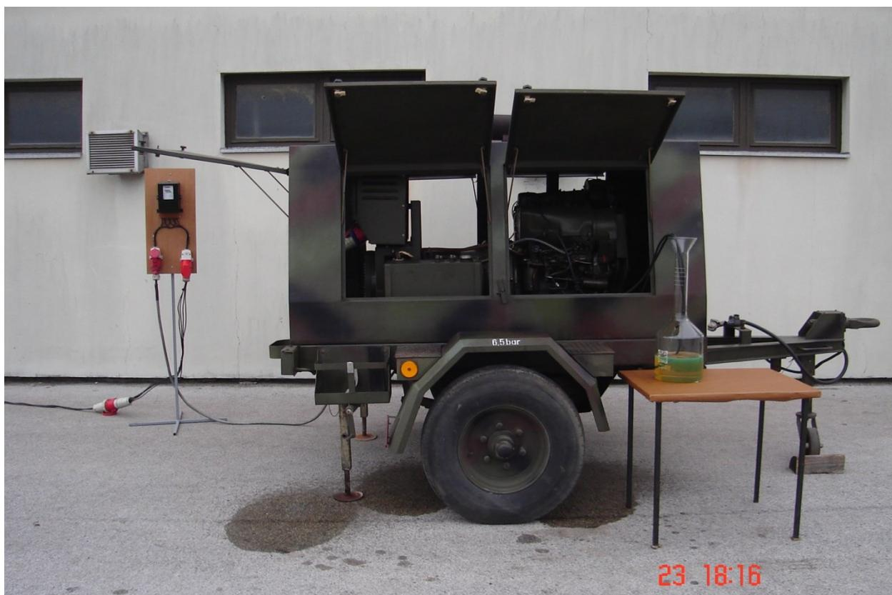
Slika 3.8. Ispitivanje elektroagregata za potrebe kategorizacije
