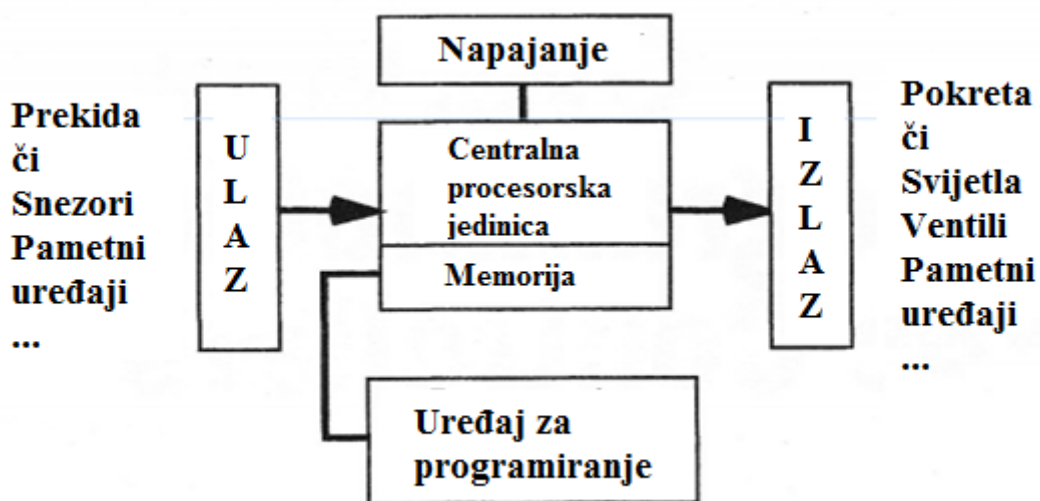
Slika 3.13 - Načelna shema industrijskog računala [10]
