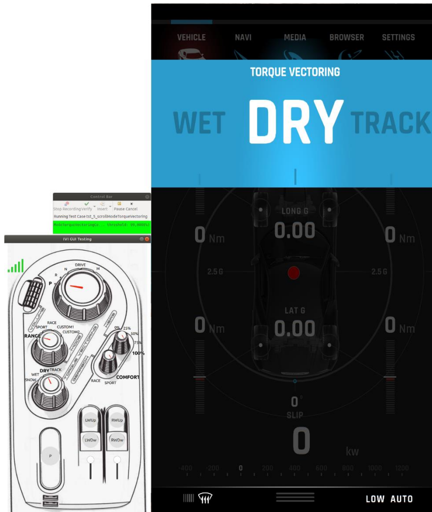
Slika 5.26. Izvođenje testiranja načina prijenosa okretnog momenta na centralnom zaslonu
