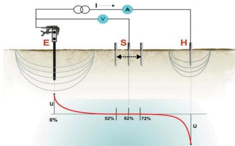
Slika 4.1 Shema mjerena otpora uzemljenja i raspodijela potencijala [2]
