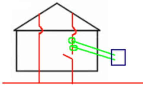
Slika 4.11 Metoda mjerena s dvijema kliještim a kada je uzemljivač otpojen
