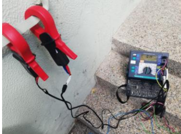
Slika 4.10 Metoda mjerenja s dvijema kliještima kada je uzemljivač spojen sa zemljovodima
