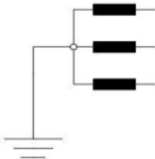
Slika 2.3 Pogonsko ili radno uzemljenje [1]
