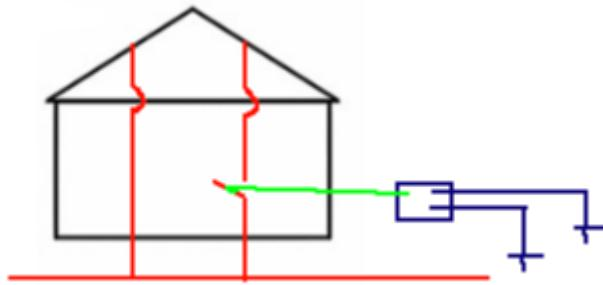
Slika 4.7 Metoda 3 voda, 2 sonde kada je uzemljivač otpojen
