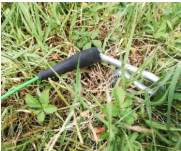
Slika 4.4 Pomoćna naponska sonda
