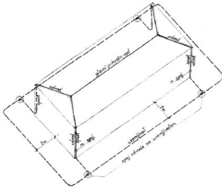
Slika 2.5 Gromobransko uzemljenje [6]
