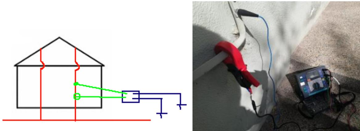
Slika 4.8 Selektivna metoda (3 voda, 2 sonde kada je uzemljivač spojen sa zemljovodima uz strujna klješta)
