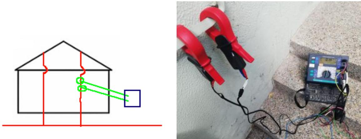
Slika 4.10 Metoda mjerenja s dvijema kliještima kada je uzemljivač spojen sa zemljovodima
