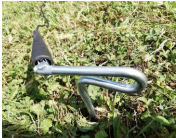
Slika 4.3 Pomoćna strujna sonda
