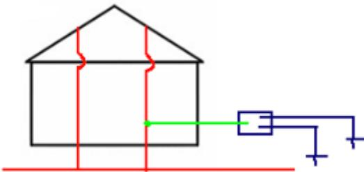
Slika 4.6 Metoda 3 voda, 2 sonde kada je uzemljivač spojen
