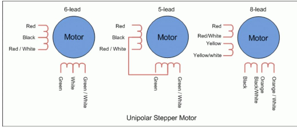
Slika 2.12. Unipolarni koračni motor može imati 5, 6 ili 8 žica [1]
