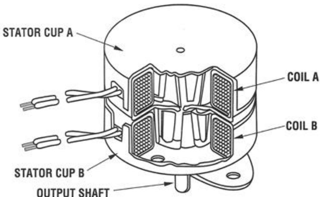
Slika 2.9. Koračni motor sa trajnim magnetom [5]
