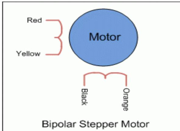
Slika 2.13. Bipolarni koračni imaju 4 žice [1]
