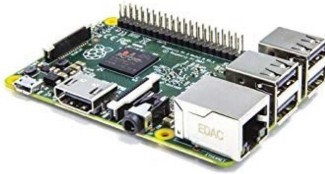
Slika 2.2 Raspberry PI 3 model B računalo
