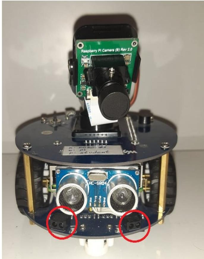
**Slika 2.7** Položaj ST188 senzora na mobilnoj platformi
