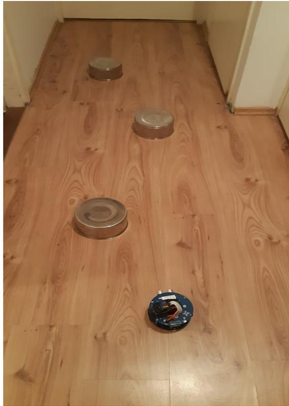
**Slika 4.1** Staza za testiranje ultrazvučnog senzora
