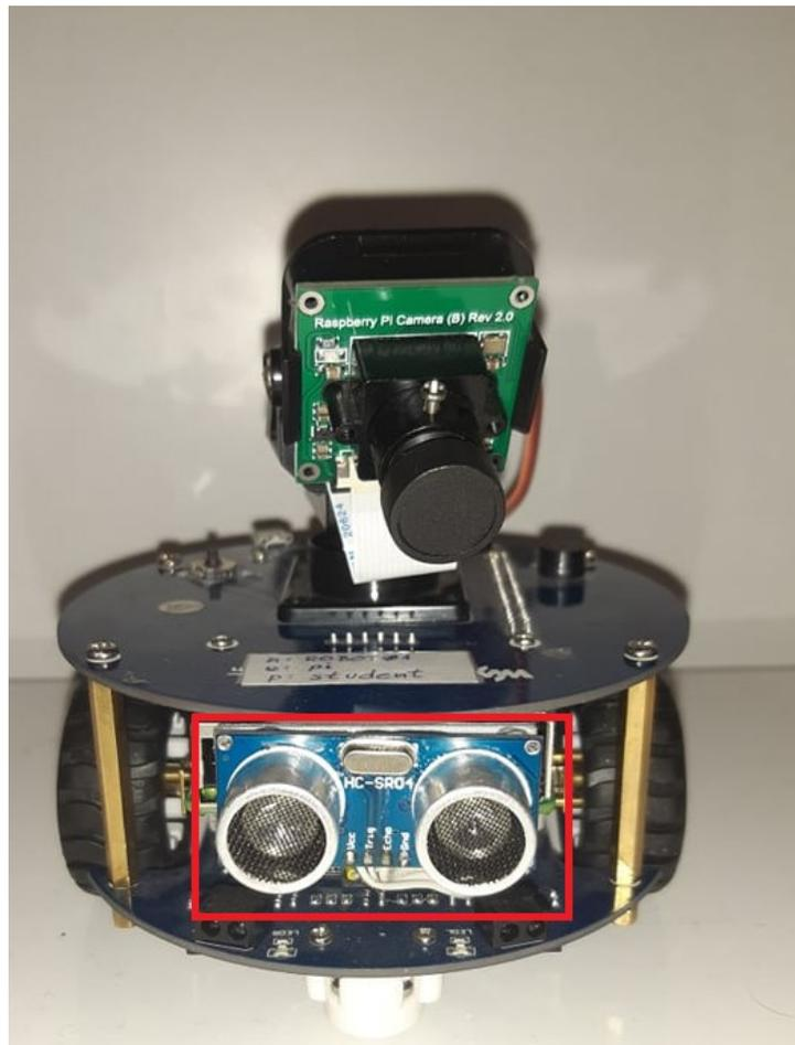
**Slika 2.5** Položaj senzora na mobilnoj platformi
