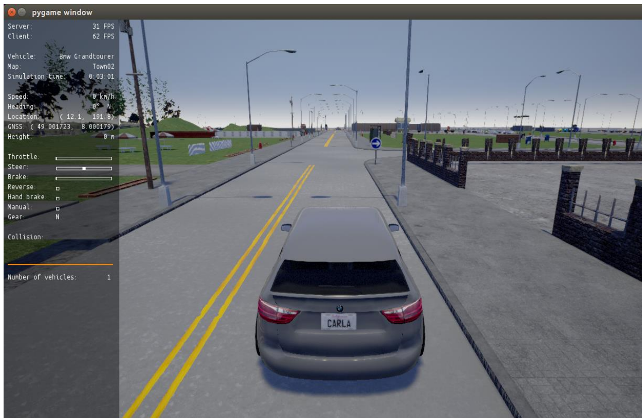
Sl. 3.16. Sučelje za upravljanje vozilom u CARLA simulatoru [24].
