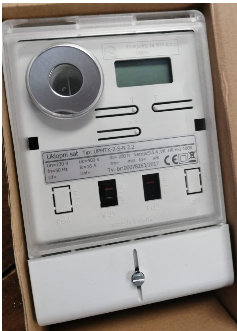
Slika 4. 9 Uklopni sat UPMTK 2-S-N 2.2., verzija 9.5.4. – Vk
