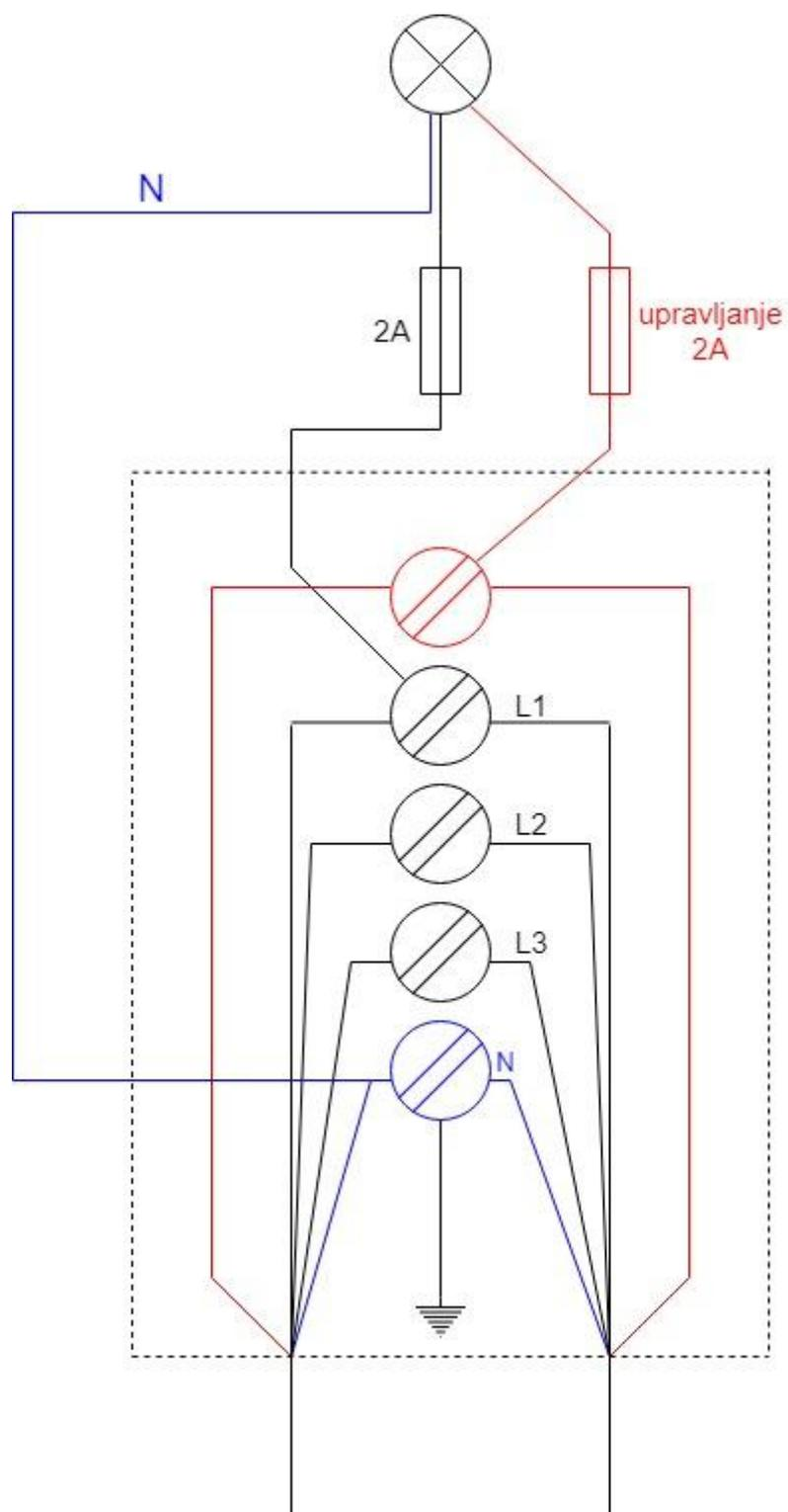
*Slika 4. 15 Shema stupne razdjelnice*
