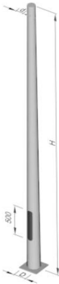
*Slika 4. 14 Rasvjetni stup tip SRS B, proizvođač Dalekovod [22]*
