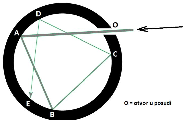
*Slika 2. 2 Apsolutno crno tijelo ostvareno na umjetan način [2]*
