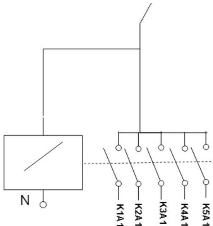
*Slika 4. 10 Kontakti glavnog sklopnika za upravljanje rasvjetom*
