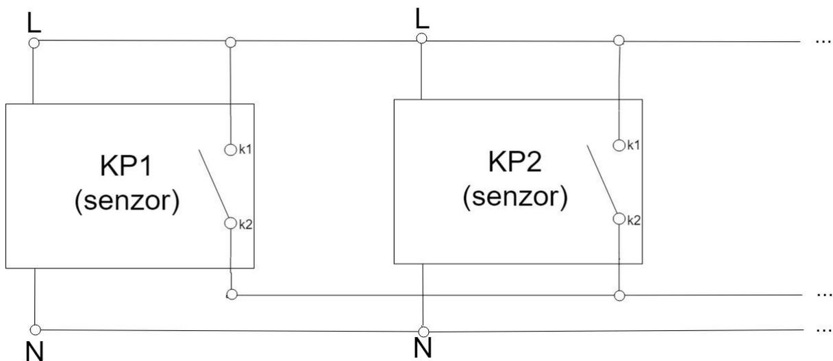
*Slika 4. 6 Spajanje dva ili više senzora u paralelu*
