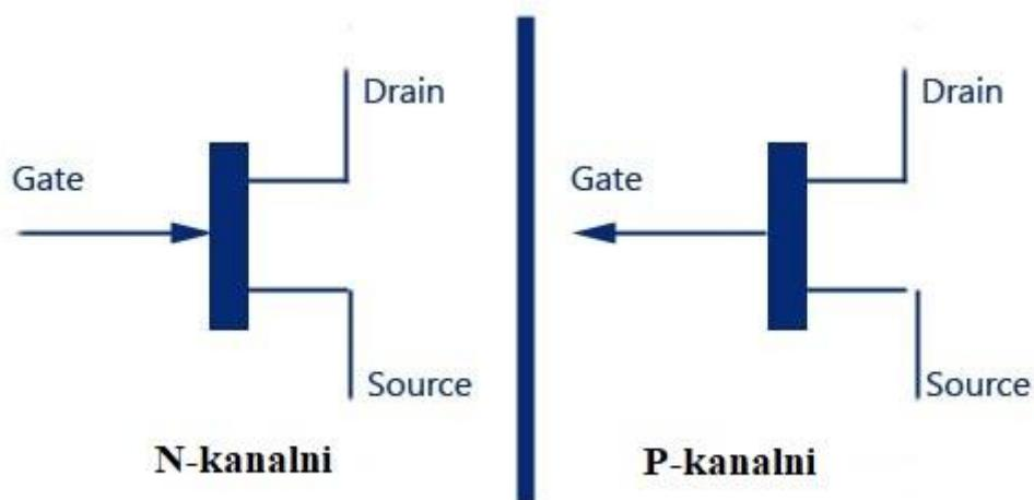
Slika 2.3. Unipolarni FET N-kanalni i P-kanalni
