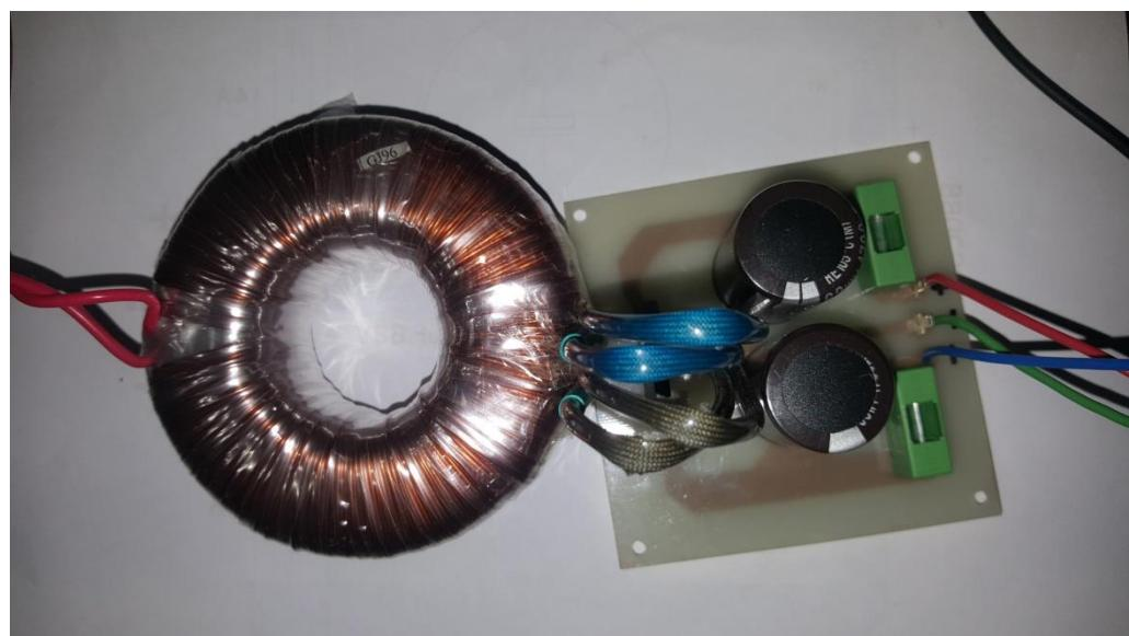
Slika 4.7. Ispravljač i transformator
