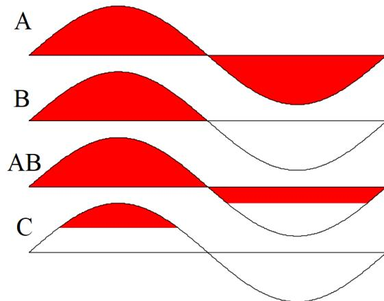
Slika 3.4. Trajanje aktivnosti izlaznog aktivnog elektroničkog elementa
