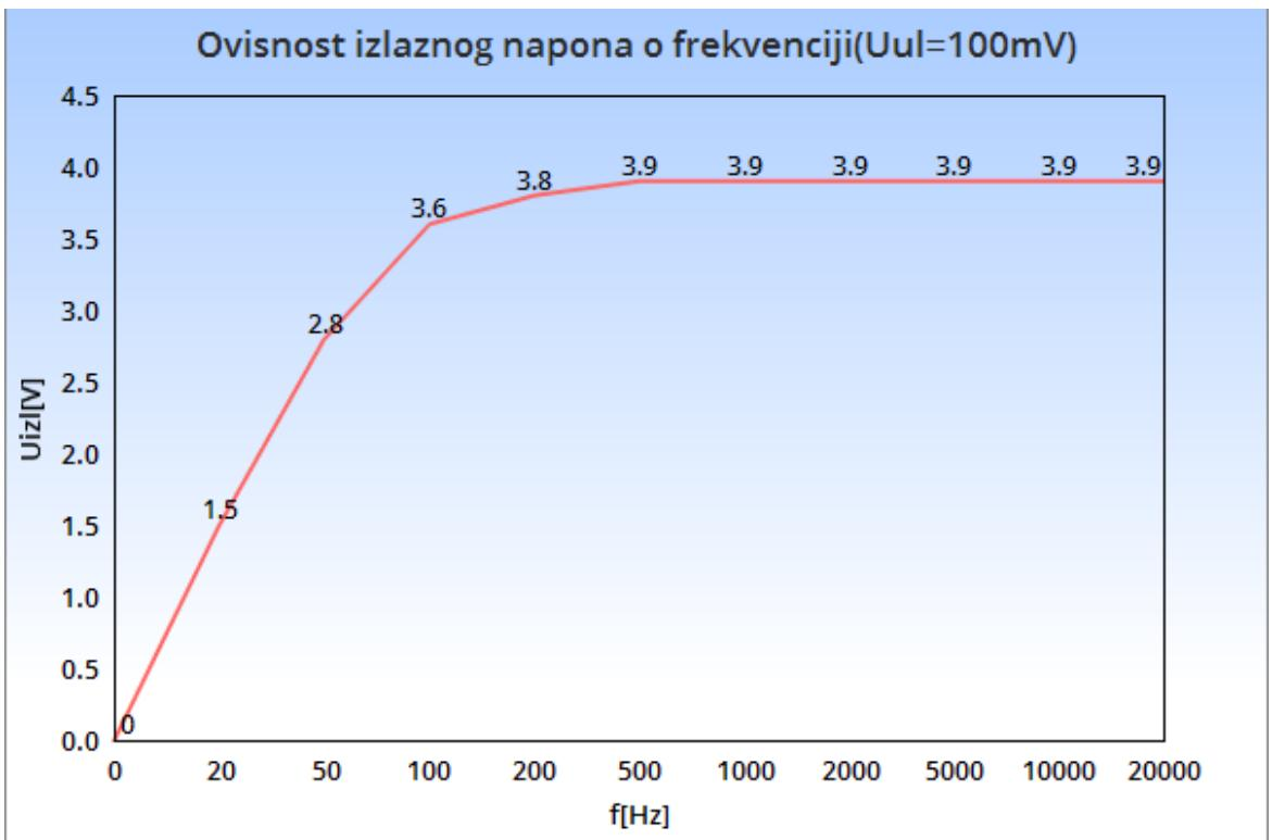
Slika 4.9. Ovisnost izlaznog napona o frekvenciji pri ulaznom naponu  $U_{ul}=100\text{mV}$
