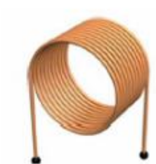
najjednostavniji senzor baziran na zavojnici
