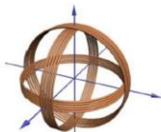
koncept s tri međusobno okomite zavojnice za mjerenje magnetskog polja
