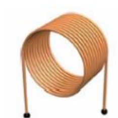
najjednostavniji senzor baziran na zavojnici
