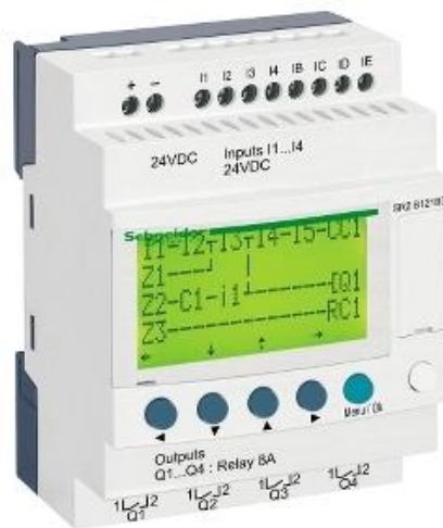
Slika 6.1. Zelio Logic programibilni relej
