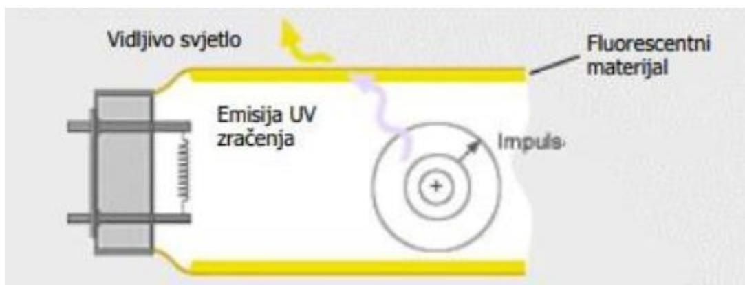
Slika 4.6. Pojednostavljeni prikaz principa rada fluorescentne cijevi
