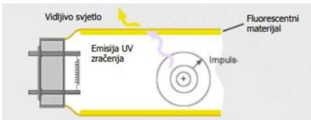
Slika 4.6. Pojednostavljeni prikaz principa rada fluorescentne cijevi
