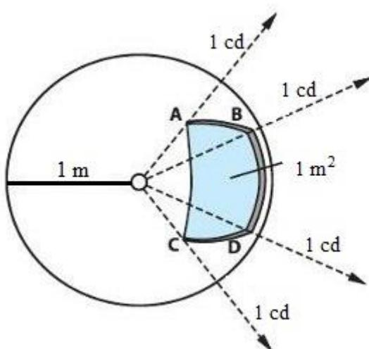
**Slika 3.3.** Jedinična kugla opisana oko točkastog izvora svjetlosti
