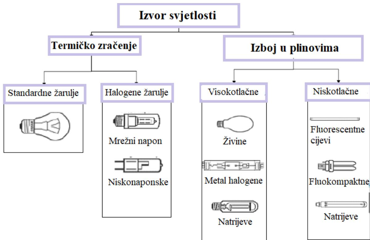
**Slika 4.1.** Podjela izvora po principu generiranja svjetlosti
