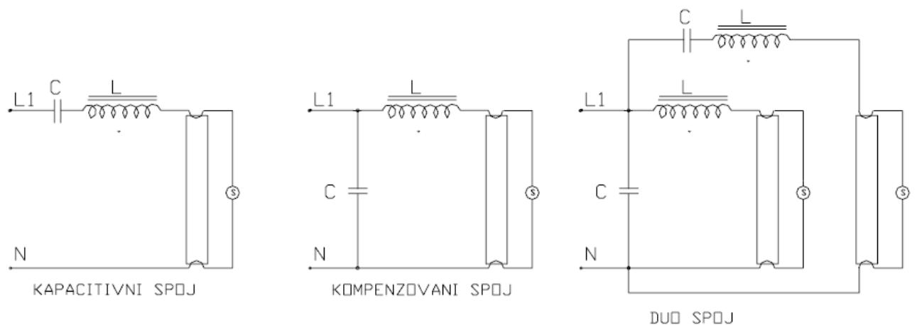
**Slika 4.8.** Kapacitivni, kompenzirani i duo spoj fluokompaktnih žarulja
