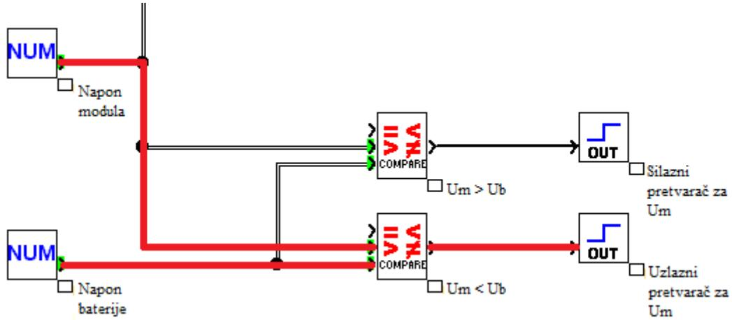
Slika 7.6. Model uzlaznog pretvarača napona FN modula
