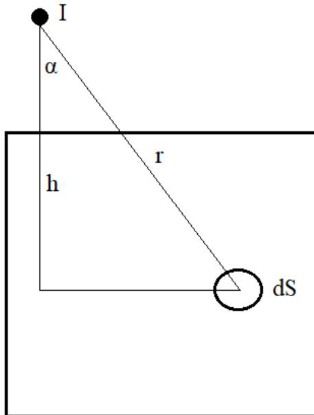
**Slika 3.5.** Određivanje rasvijetljenosti površine u određenoj točki
