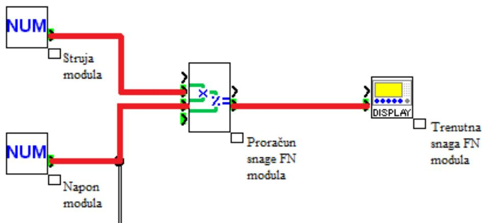
Slika 7.1. Model za proračun trenutne snage FN modula
