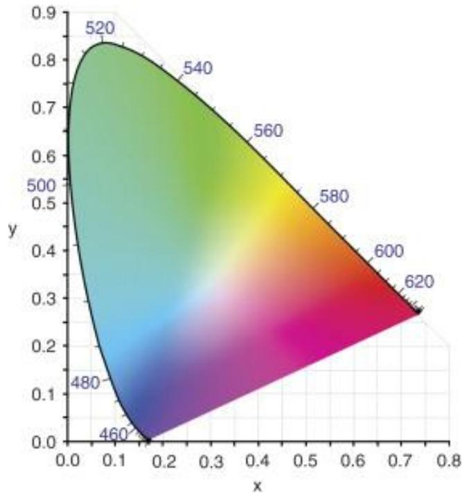
**Slika 2.2.** Trikromatski dijagram
