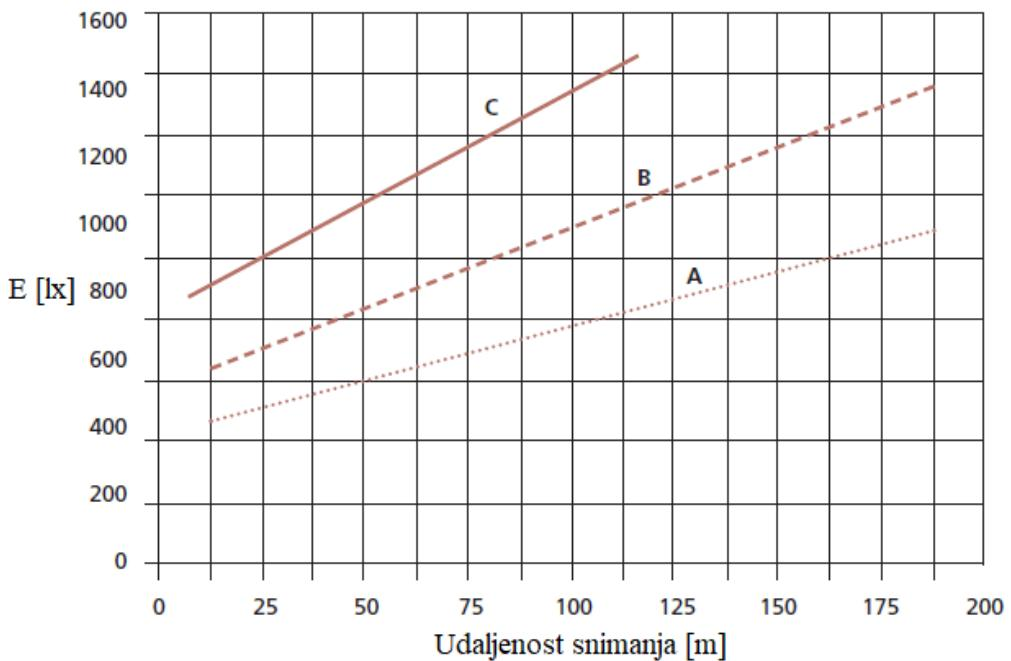
**Slika 5.4.** Opseg minimalno potrebne vertikalne rasvijetljenosti ovisno o udaljenosti snimanja
