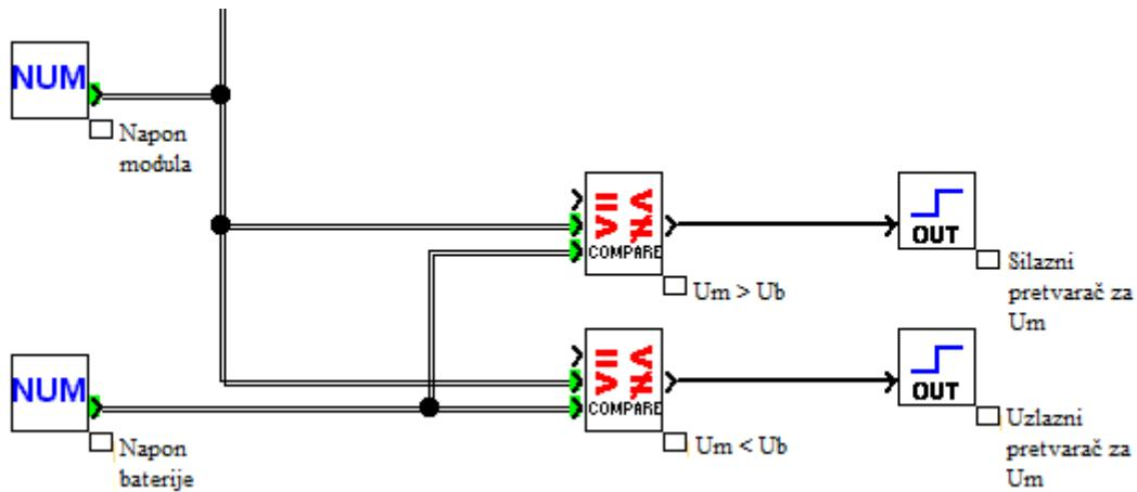
**Slika 7.4.** Model uzlaznog i silaznog pretvarača naponu
