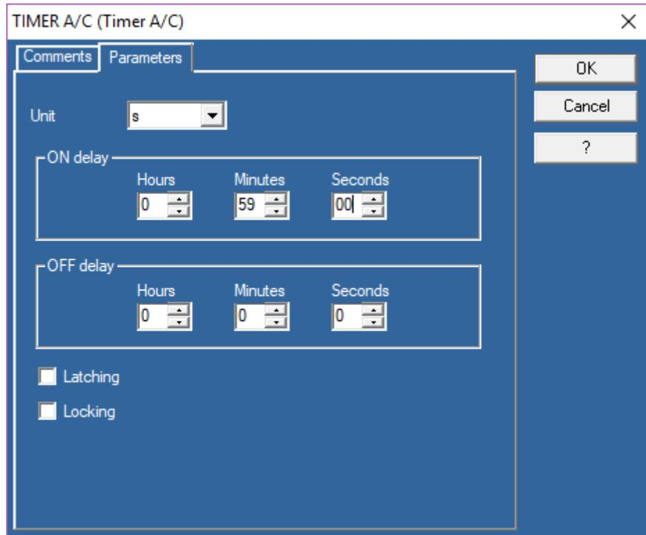
**Slika 6.19.** Postavljanje parametara u elementu „Timer A/C“
