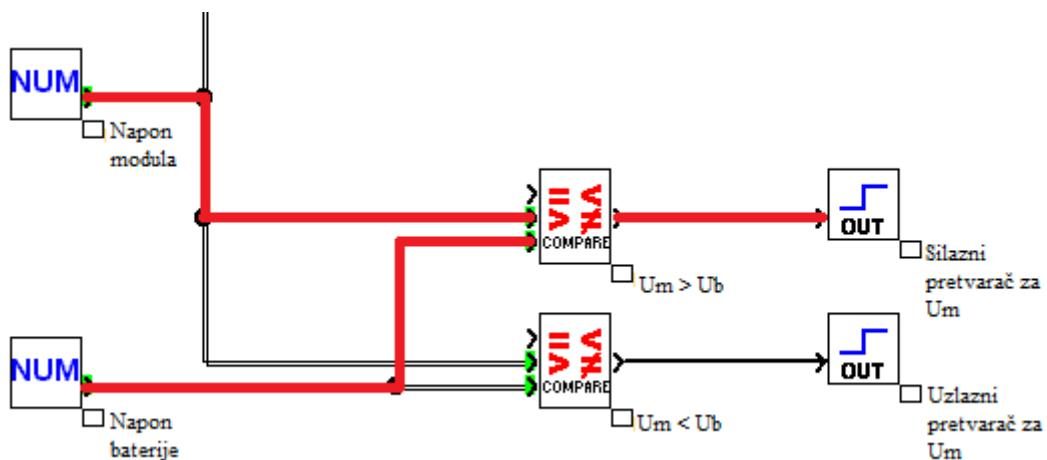
**Slika 7.5.** Model silaznog pretvarača naponu FN modula
