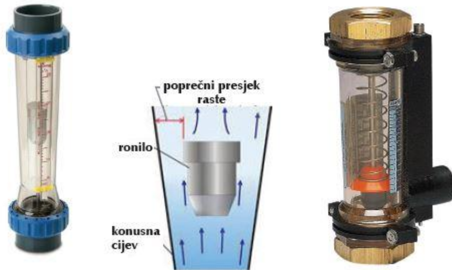
Slika 2.6. Rotametar [10].
