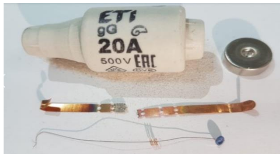
Slika 5.24. Osigurač veličine D II, razreda gG, marke ETI, nazivne struje 20 A, kojemu je glavna nit pregorjela, dok kontrolna nit nije
