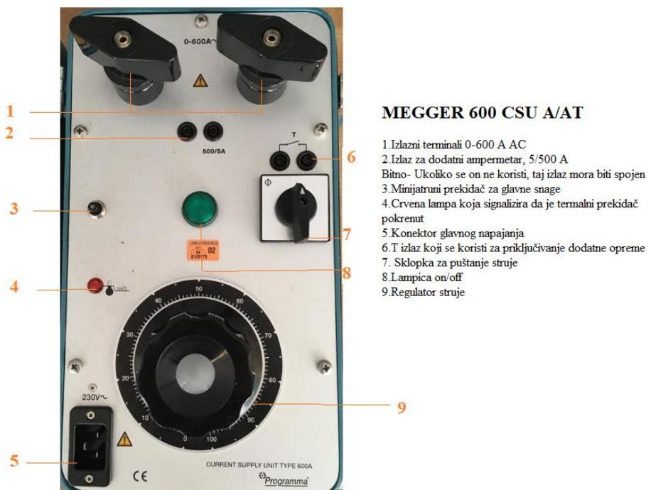
**Slika 4.3.** Strujni izvor MEGGER CSU 600 A-AT
