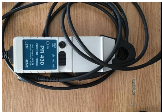
Slika 4.5. PR 430 Strujna kliješta
