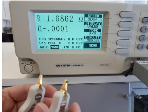
Slika 5.25. Mjerenje otpornosti kontrolne niti osigurača veličine D II, razreda gG, marke ETI nazivne snage 6 A
