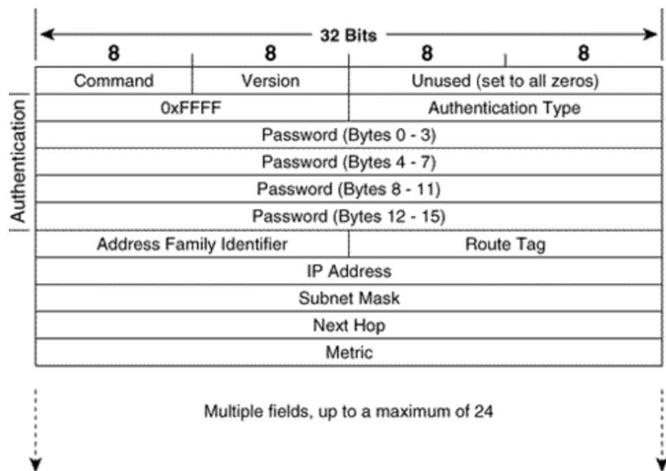
Slika 3.5 Format RIPv2 poruke s konfiguiranom autentifikacijom[8]
