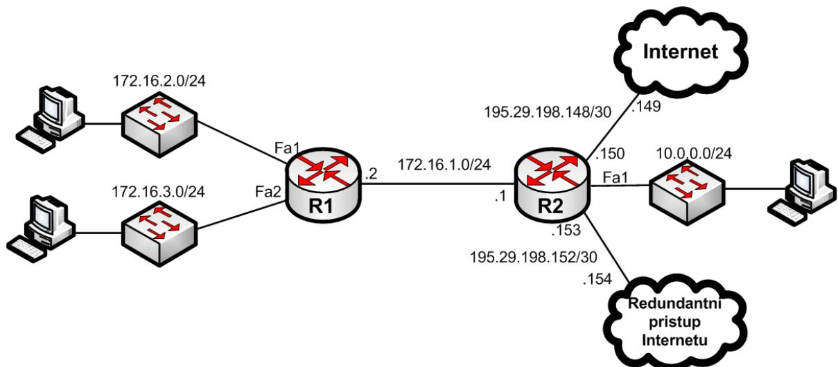
Slika 2.4. Prikaz cjelokupne mreže s konfiguiranim statičkim usmjeravanjem
